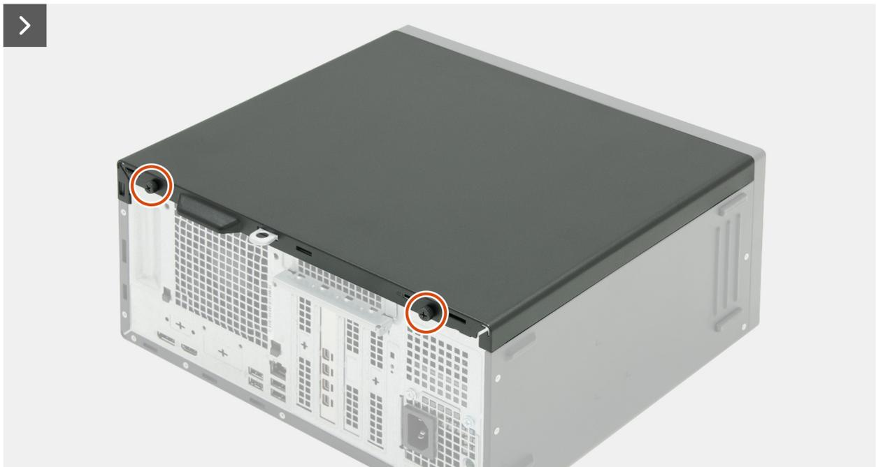
Figura13. Retirar a tampa do lado esquerdo
