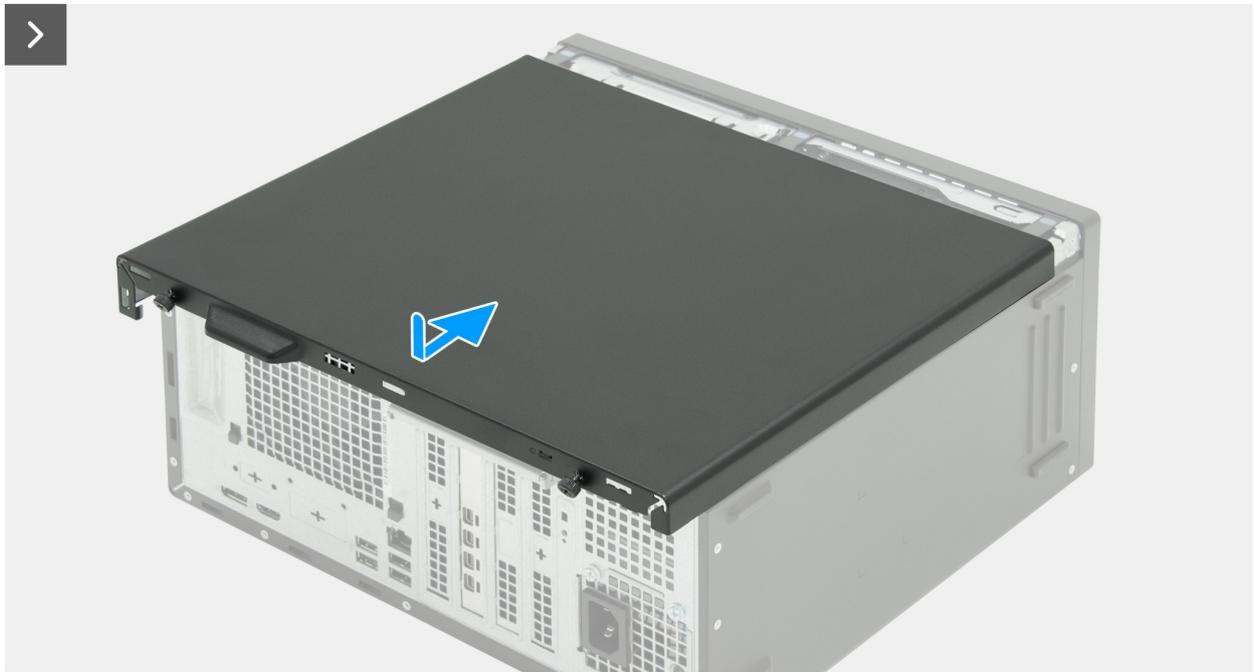
Figura15. Instalar a tampa lateral esquerda
