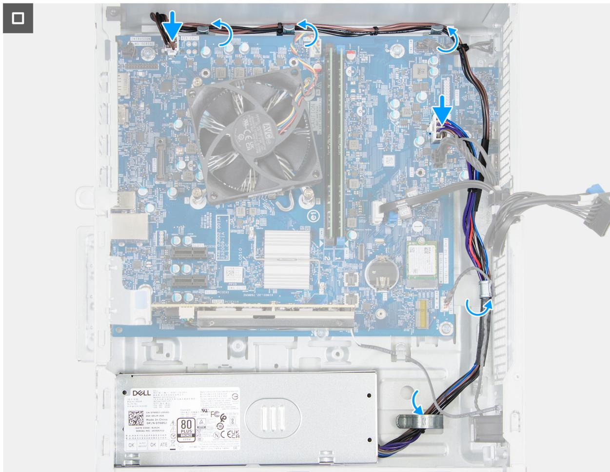
**Figura65. Instalar a unidade de fonte de alimentação**
