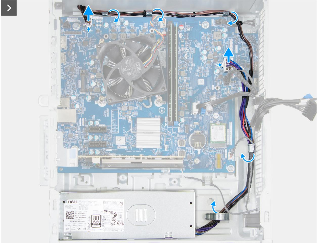
Figura62. Retirar a unidade de fonte de alimentação
