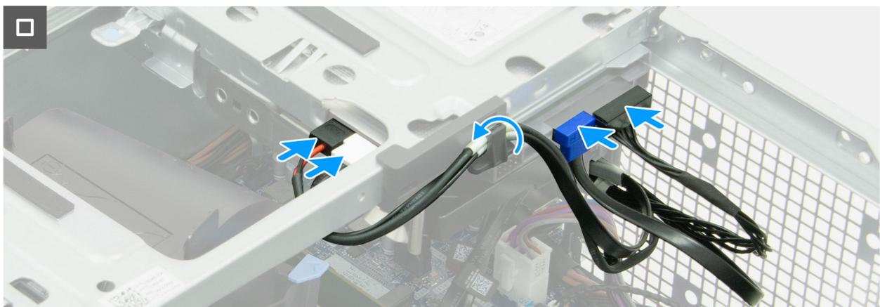
Figura45. Instalar o compartimento de disco
