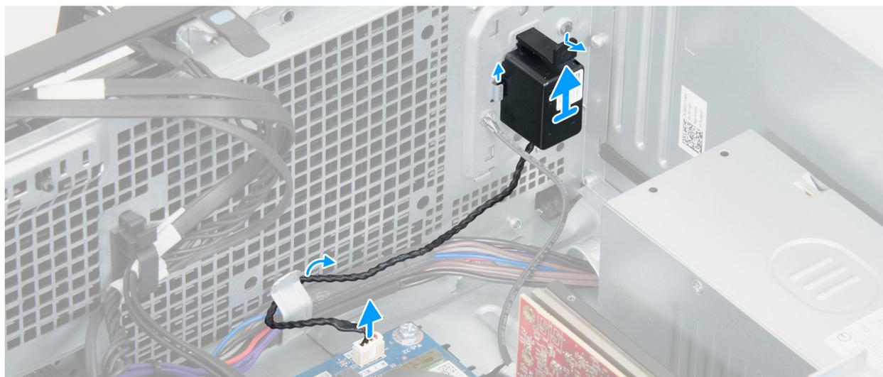
**Figura25. Retirar a coluna interna**
