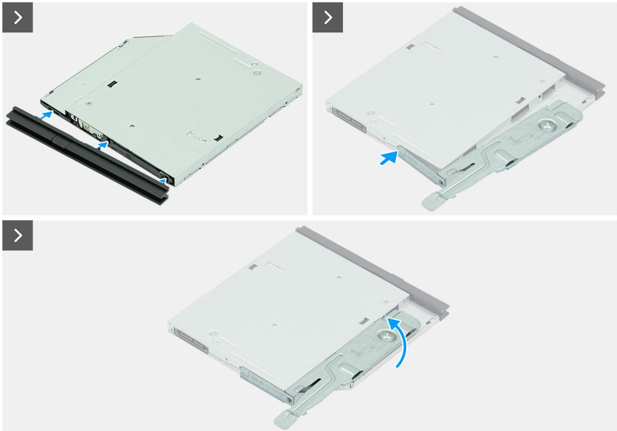
Figura40. Instalar o disco ótico
