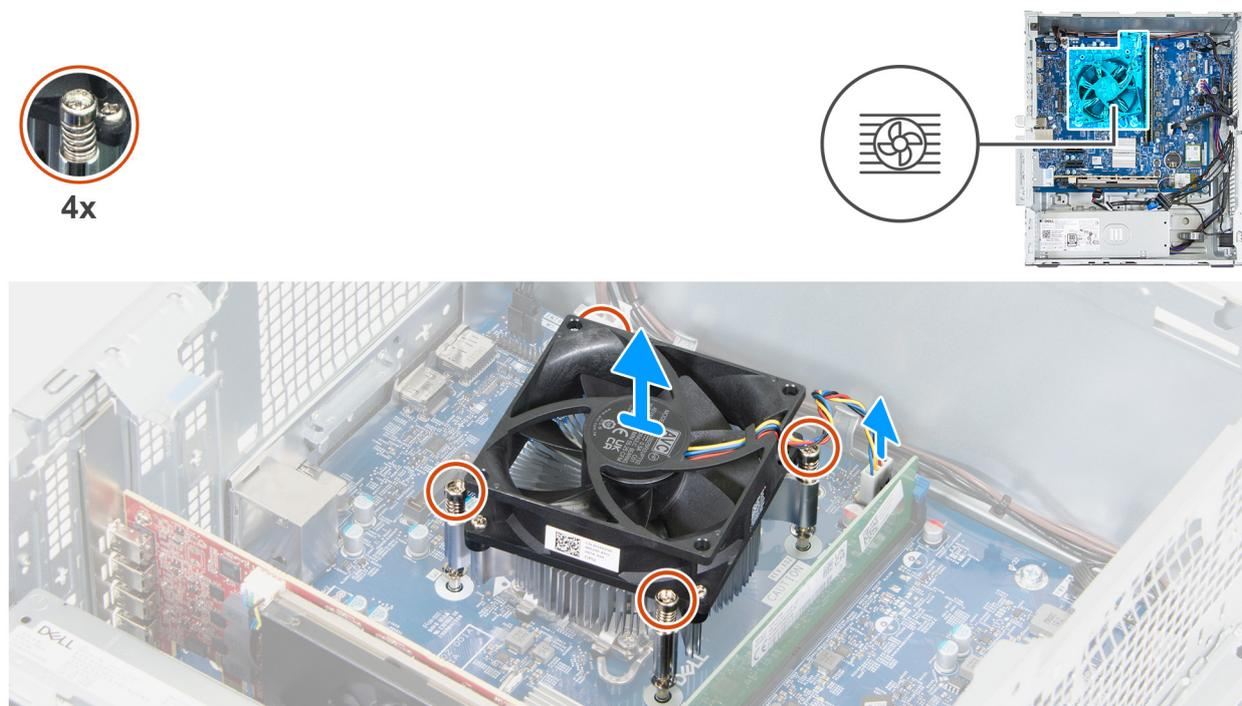
**Figura66.** Retirar o conjunto da ventoinha e dissipador de calor do processador
