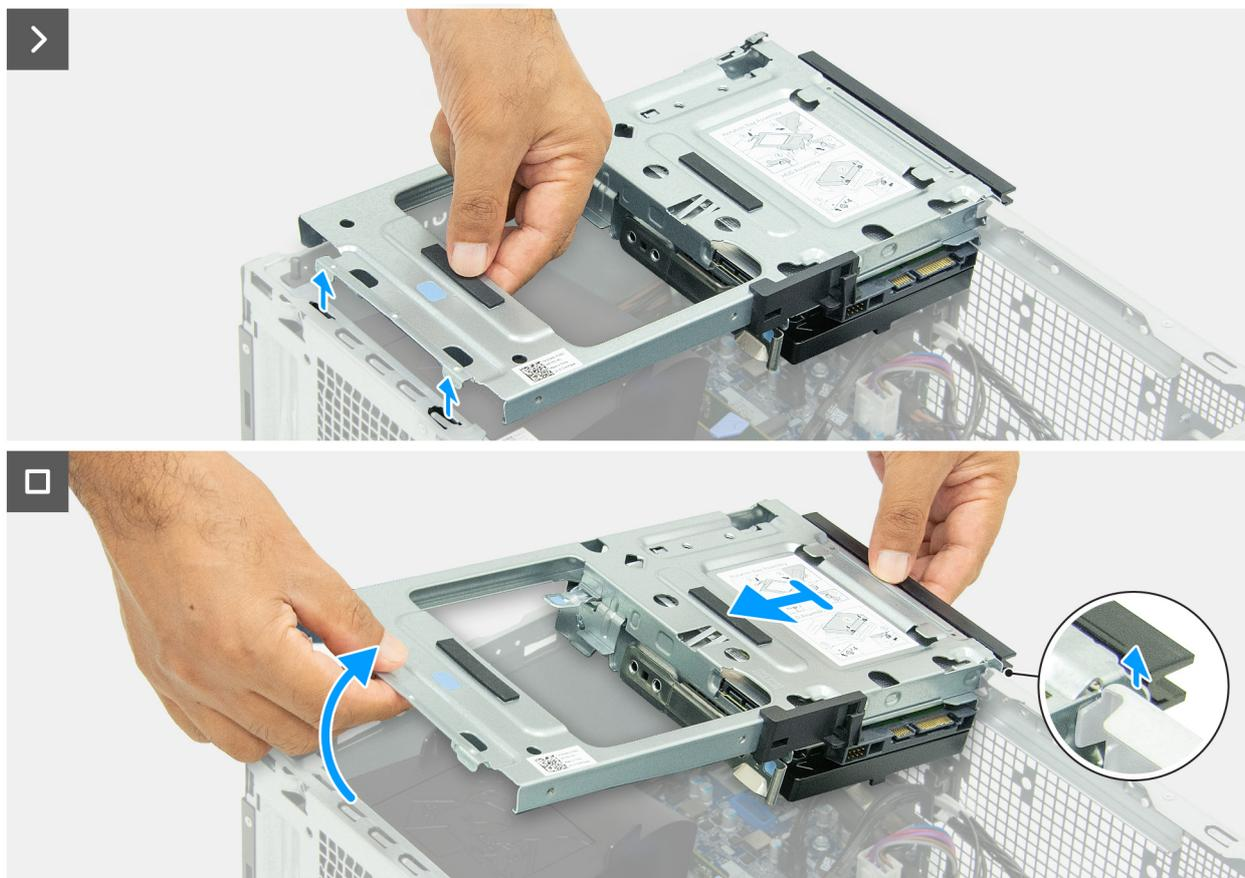
**Figura43. Retirar o compartimento de disco**
