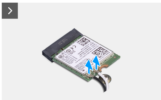
Obrázek 40. Demontáž bezdrátové karty
