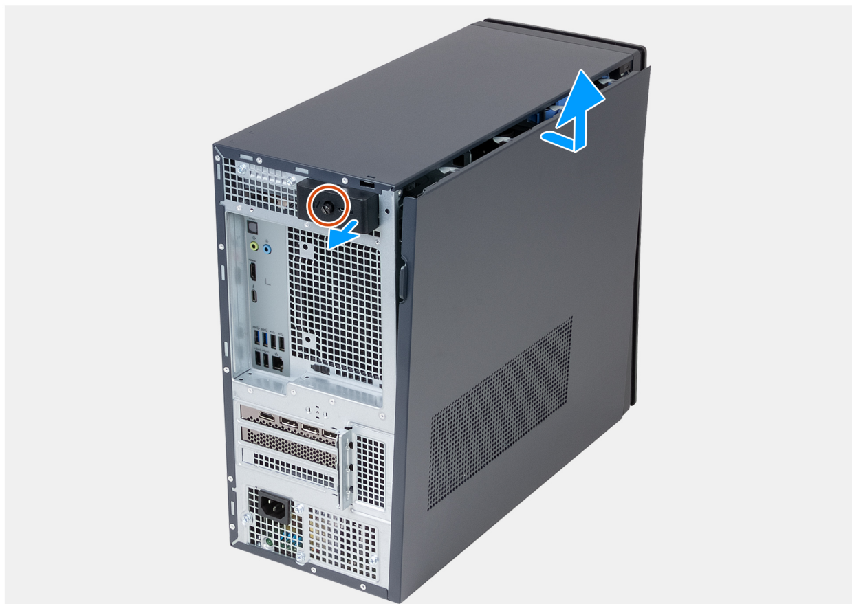
Obrázek 10. Demontáž levého bočního krytu
