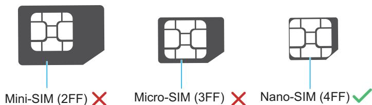
Individuare l'alloggiamento per le schede Nano-SIM e inserire una scheda Nano-SIM come illustrato di seguito. Chiudere il coperchio dell'alloggiamento della scheda Nano-SIM dopo averla inserita.
