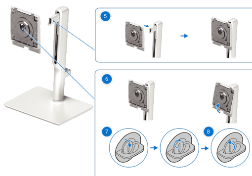
Rysunek 13. Instalacja pokryw VESA do płyty wspornika
