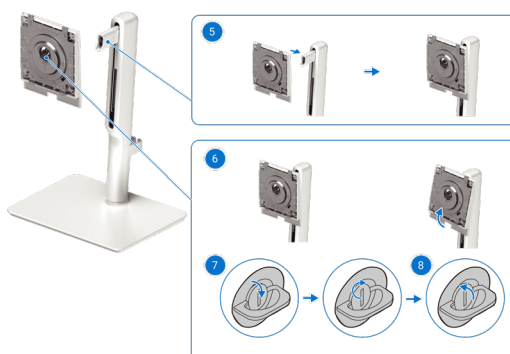
Figure 13. Installez le couvercle VESA et la colonne de support
