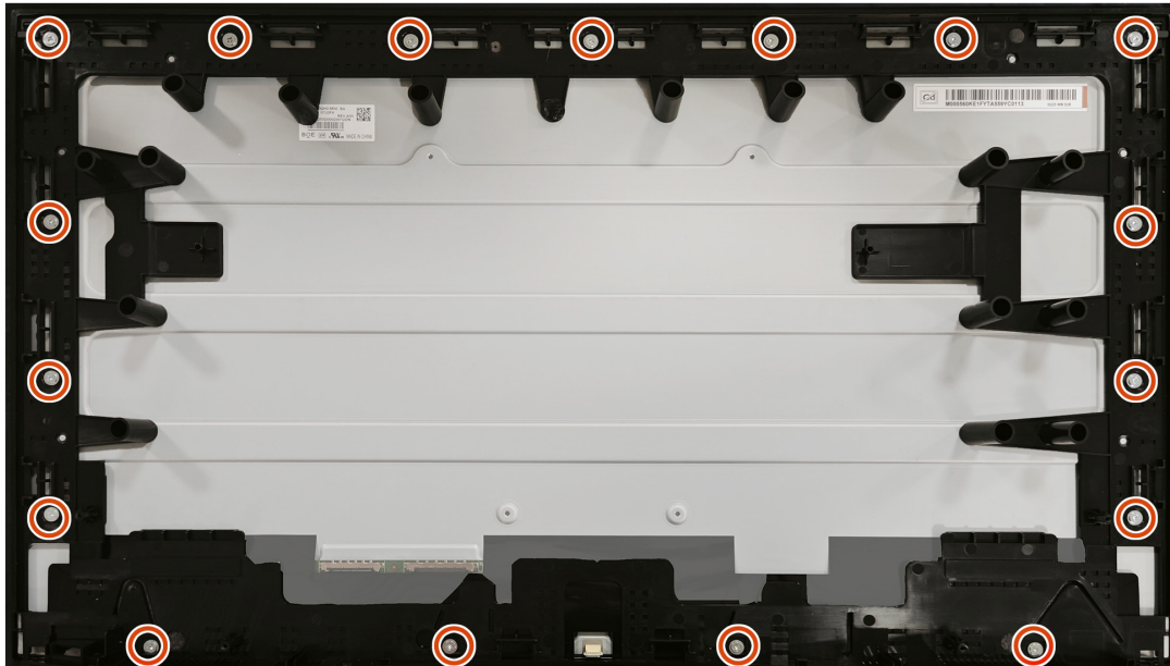
Figure 26. Installer le cadre central
