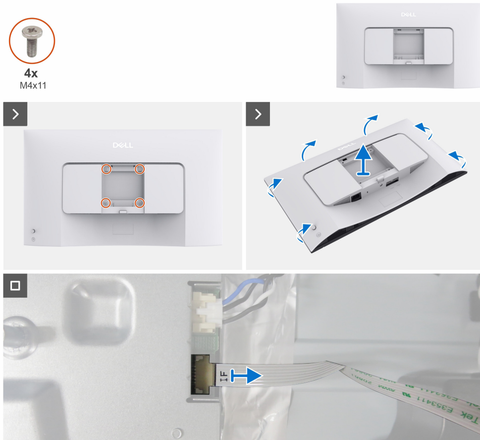
Figure 3. Retrait du couvercle arrière
