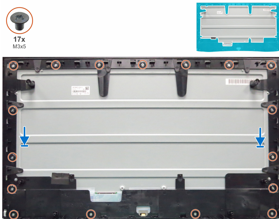
Figure 14. Installation du cadre intermédiaire pour S2725HSM
