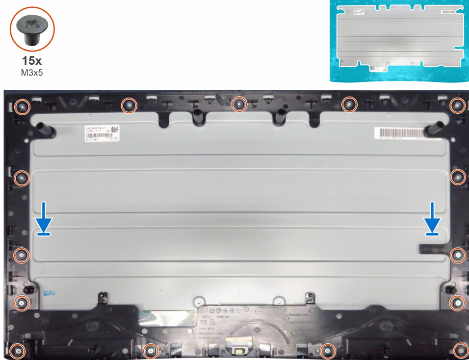
Figure 13. Installation du cadre intermédiaire pour S2425HSM
