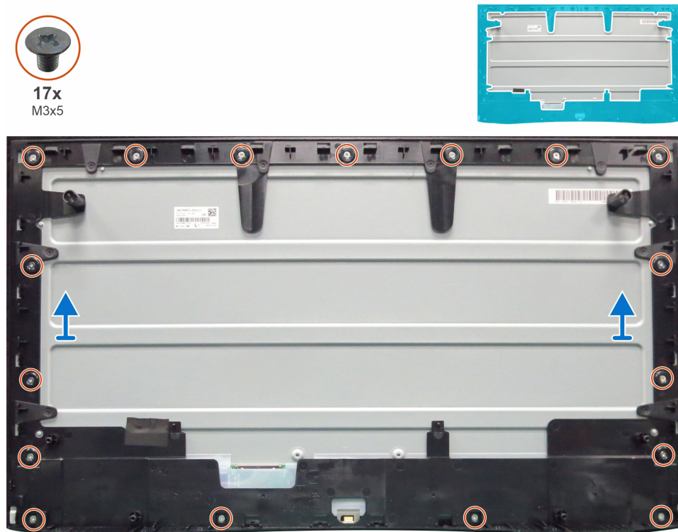
Figure 21. Retrait du cadre intermédiaire pour S2725HSM
