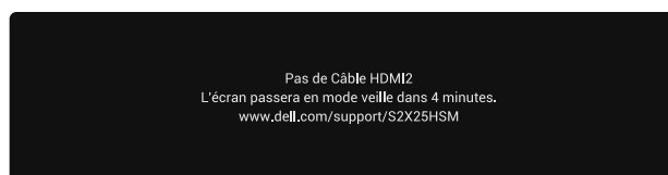
Figure 35. Message d'avertissement de câble HDMI 2 débranché
