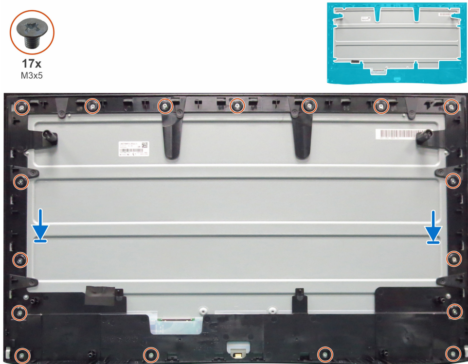
Figura 14. Instalación del marco central para el modelo S2725HSM
