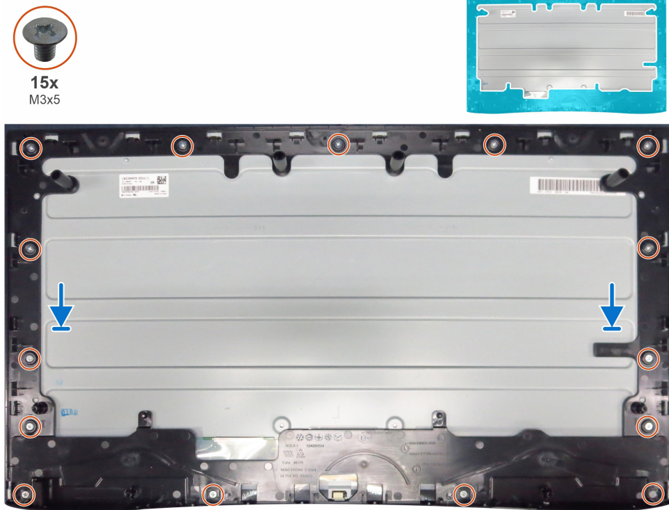
Figura 13. Instalación del marco central para el modelo S2425HSM
