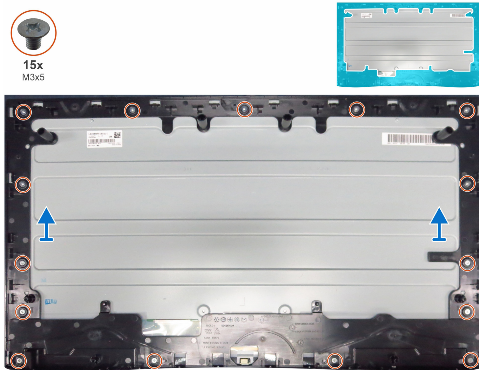
Figura 11. Desmontaje del marco central para el modelo S2425HSM
