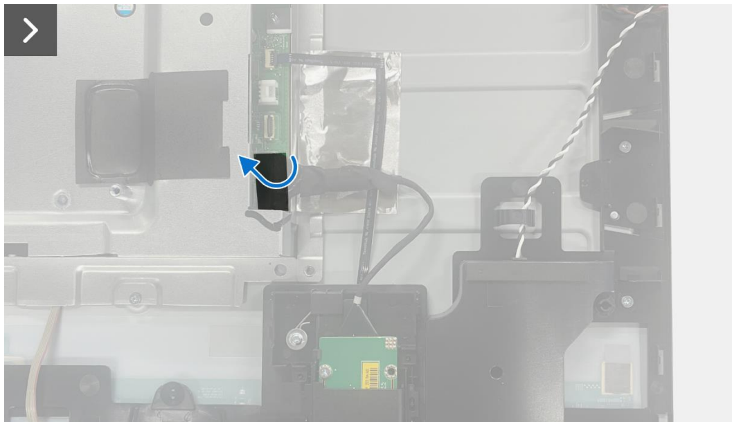
Ilustracja 28. Usuwanie płyty QAP
