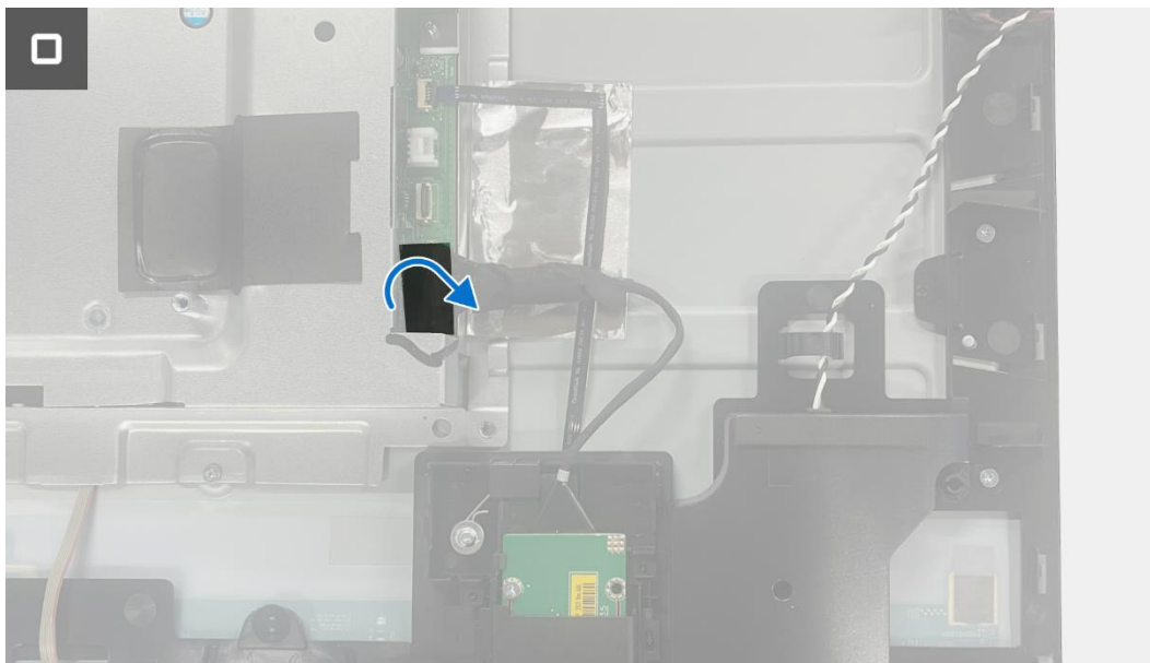
Ilustracja 33. Instalacja płyty QAP
