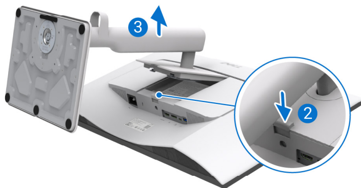
Figure 27. Retrait du socle du moniteur
