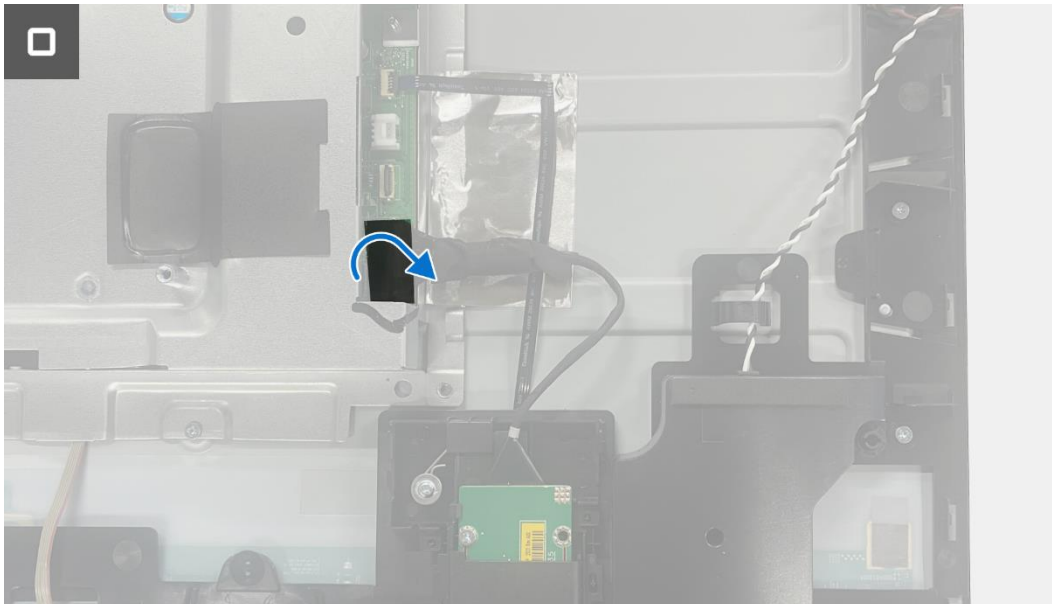
Figure 33. Installation de la carte QAP
