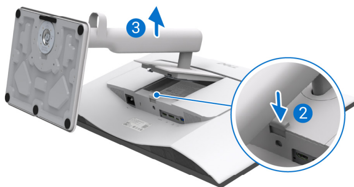
Figura 27. Desmontaje del soporte del monitor
