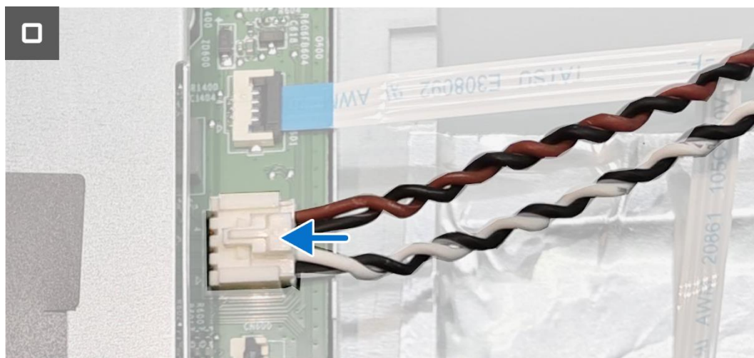
Figura 17. Instalación de los altavoces
