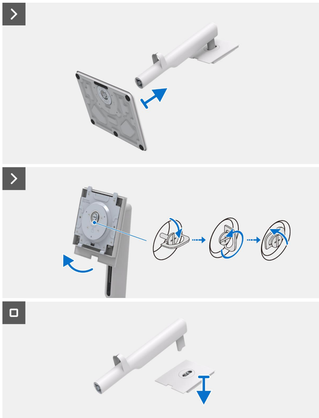
Figura 2. Desmontaje del soporte
