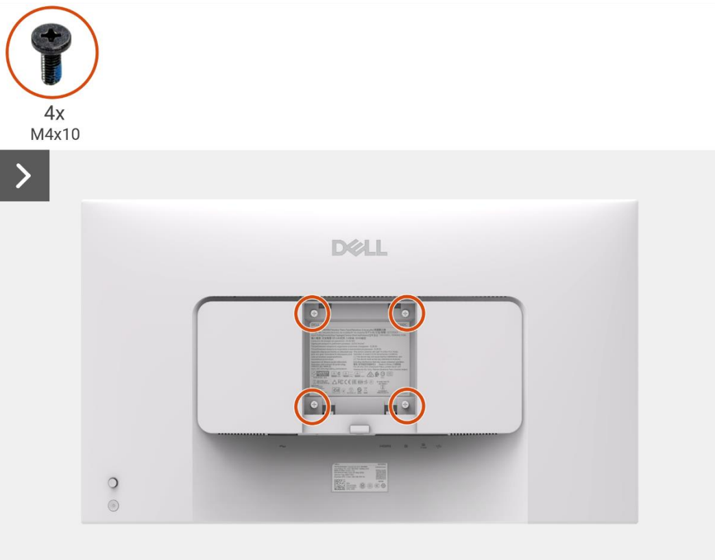
Figura 6. Desmontaje de la tapa trasera
