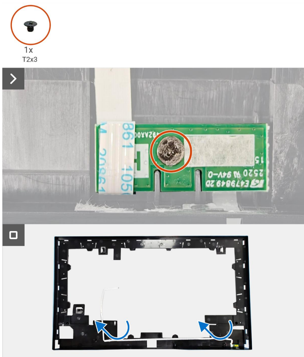
Figura 39. Desmontaje la placa LED
