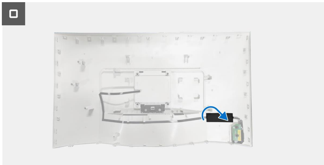
Figura 13. Instalación de la placa de teclado
