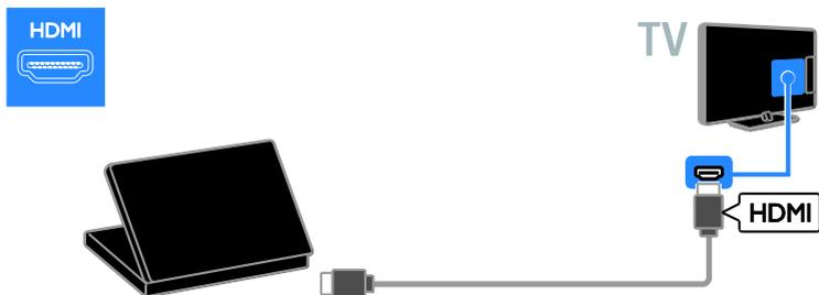
Conecte el ordenador con un cable DVI-HDMI y un cable de audio al televisor.
