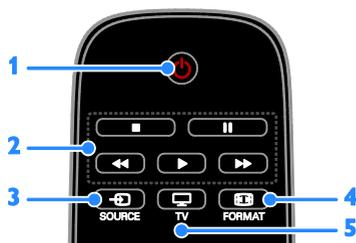
1. **⏻ (Modo de espera):** permite encender el televisor o cambiarlo al modo de espera.
