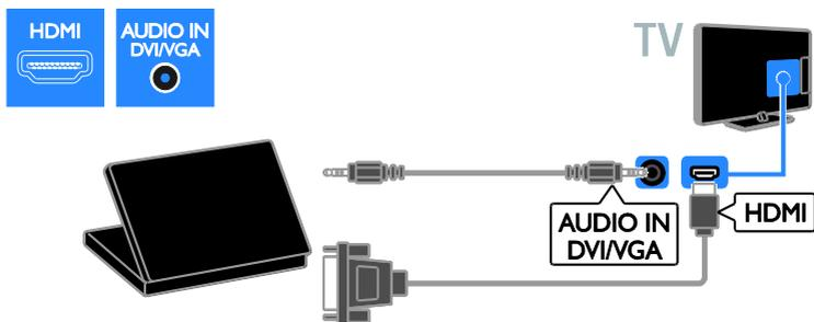
Conecte el ordenador con un cable VGA y un cable de audio al televisor.
