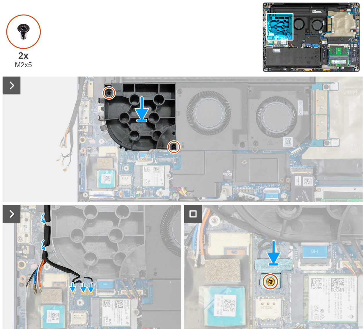
Figure 60. Installation du ventilateur factice
