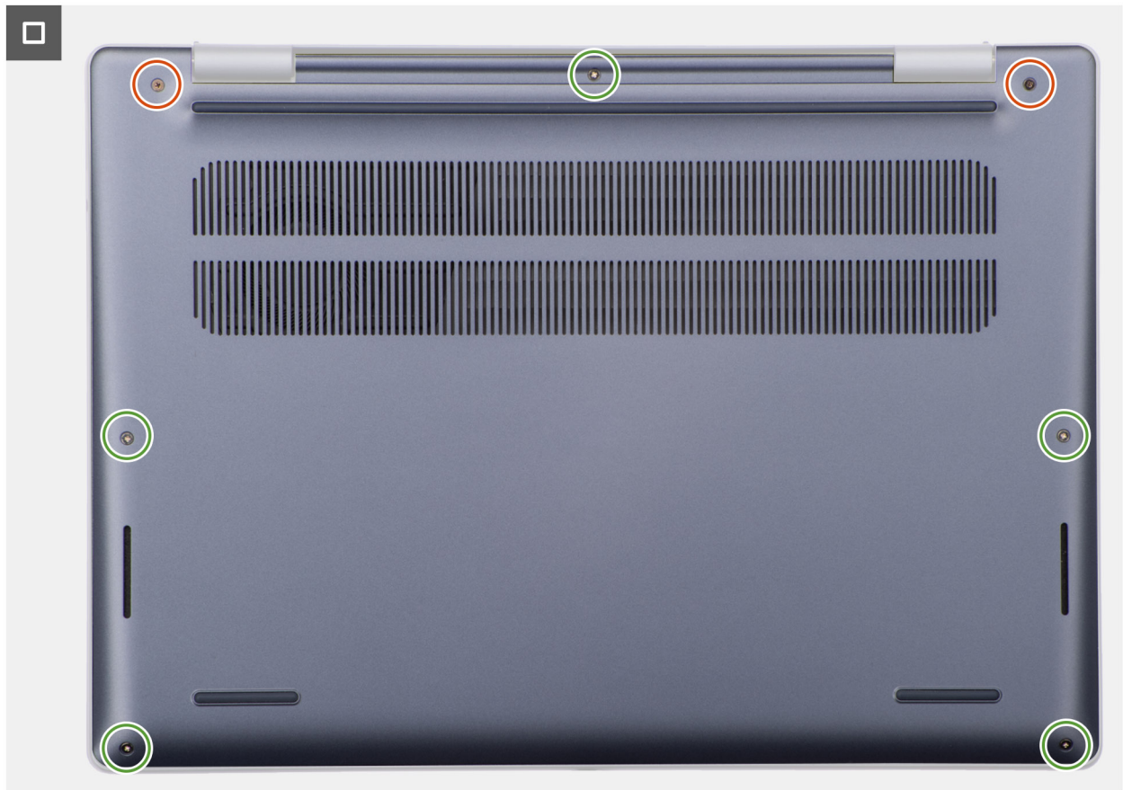
Abbildung 19. Anbringen der Bodenabdeckung
