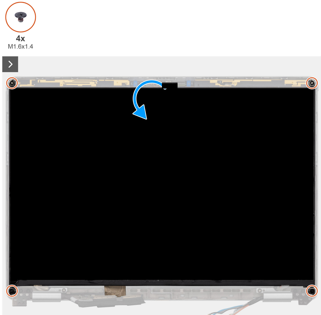
Afbeelding 68. Het beeldschermpaneel verwijderen
