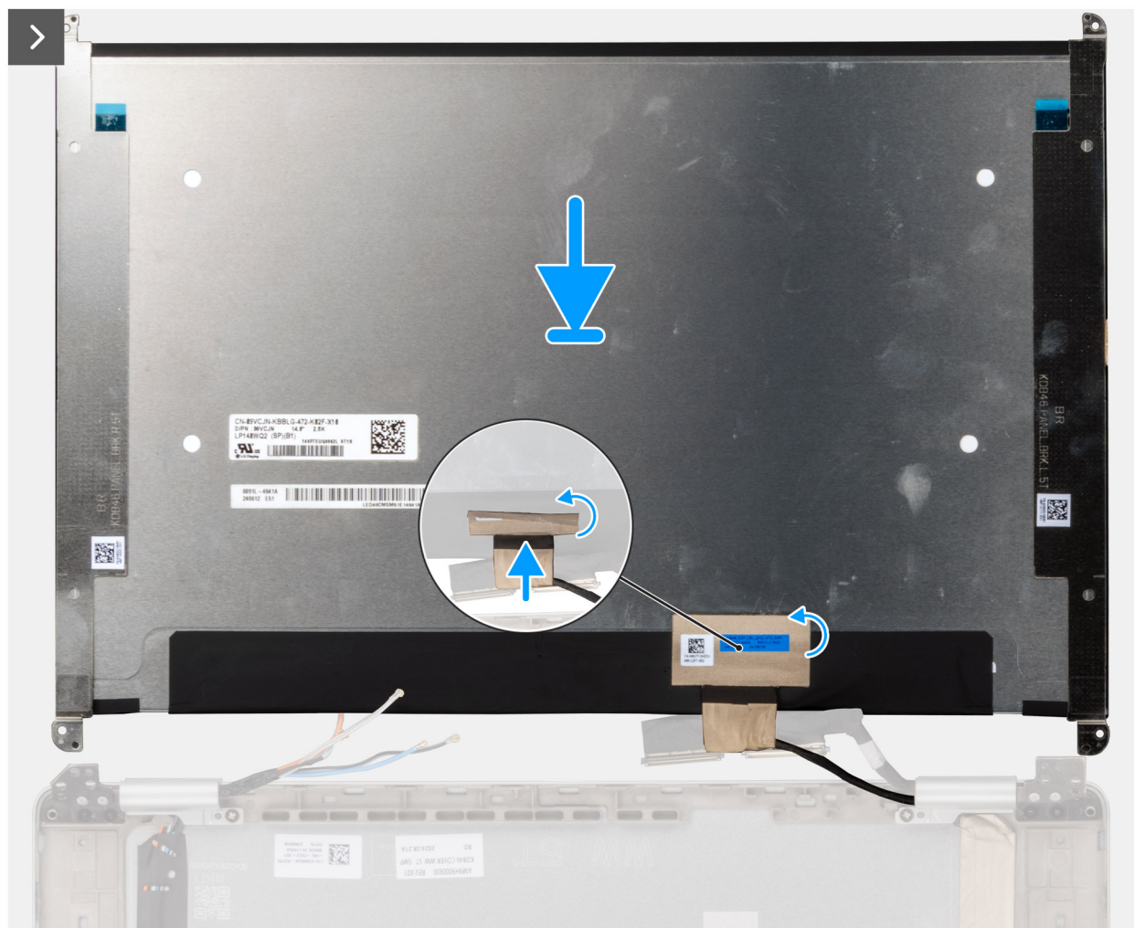
Afbeelding 71. Het beeldschermpaneel installeren
