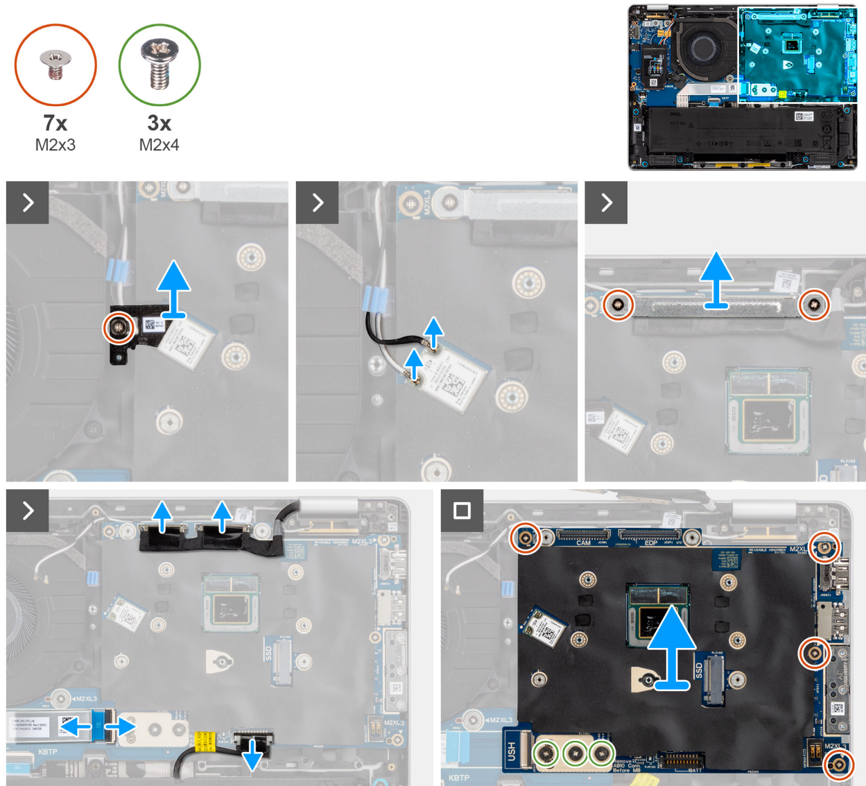
Afbeelding 48. De systeemkaart verwijderen
