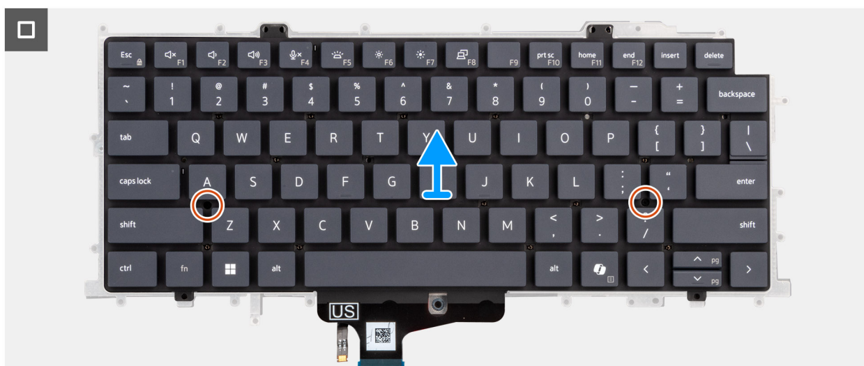
Afbeelding 82. Het toetsenbord verwijderen
