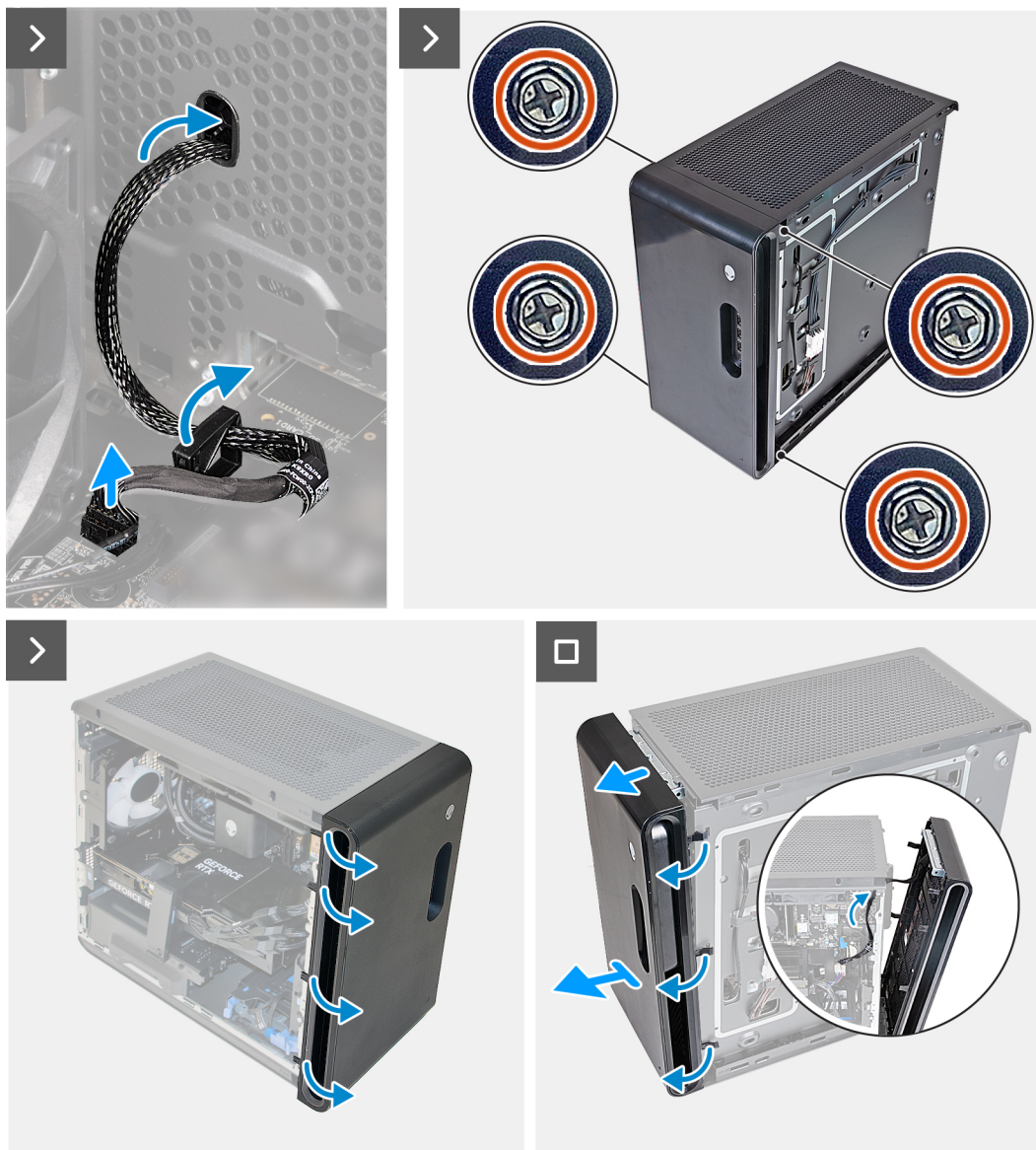
Afbeelding 18. Het montagekader aan de voorkant verwijderen
