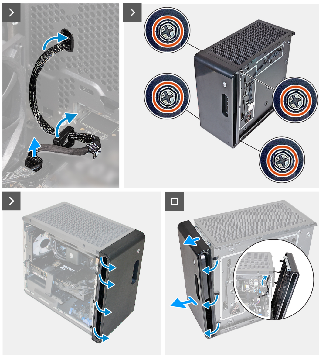
Abbildung 18. Entfernen der Frontverkleidung
