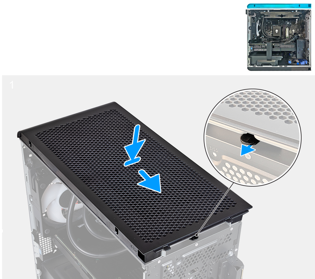
Abbildung 21. Anbringen der oberen Abdeckung
