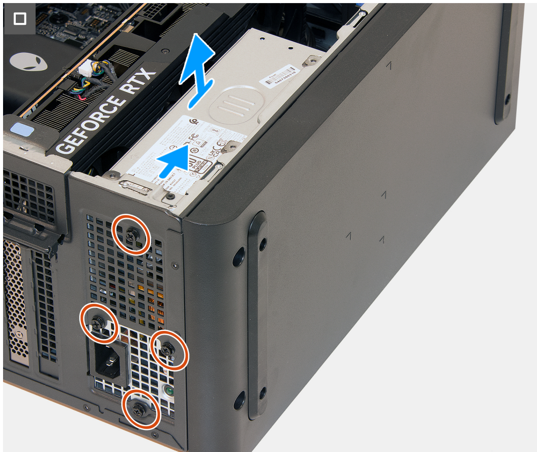
Abbildung 46. Entfernen der Stromversorgungseinheit
