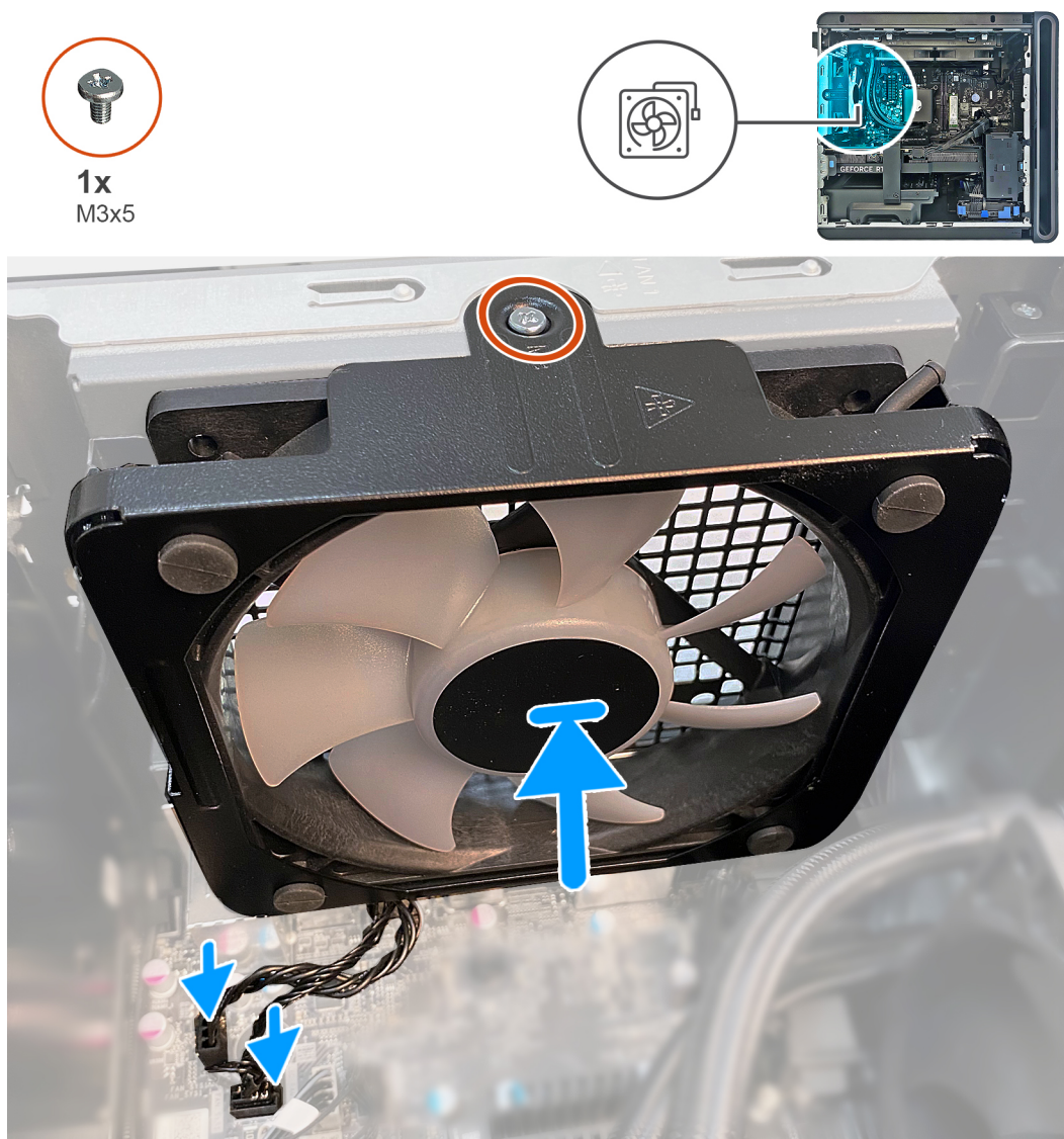
Figure 44. Installation du ventilateur arrière du boîtier
