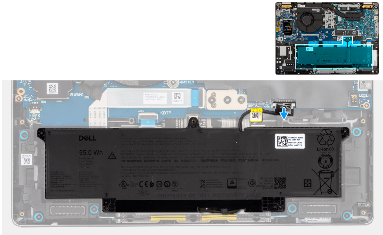
Figure 24. Déconnexion du câble de la batterie
