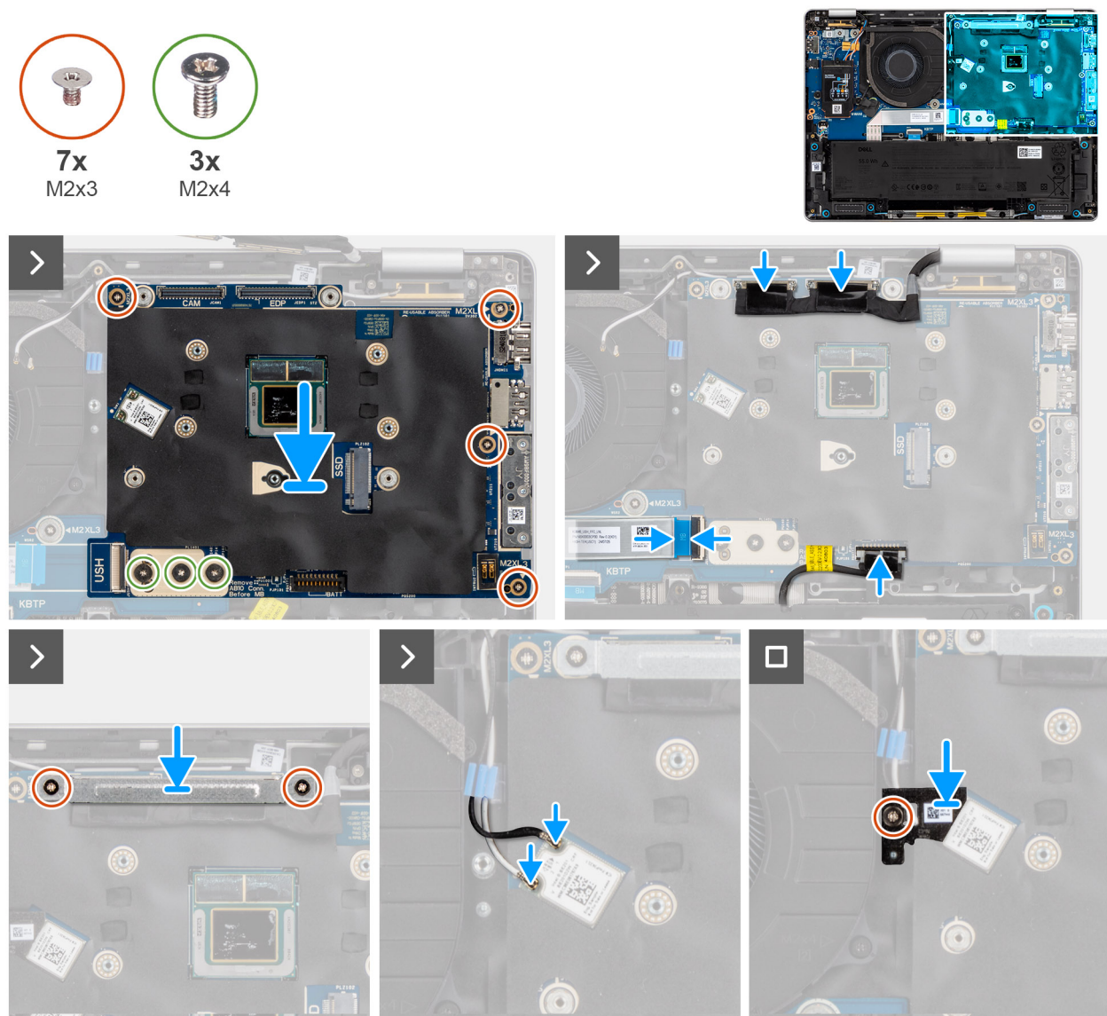
Figure 50. Installation de la carte système
