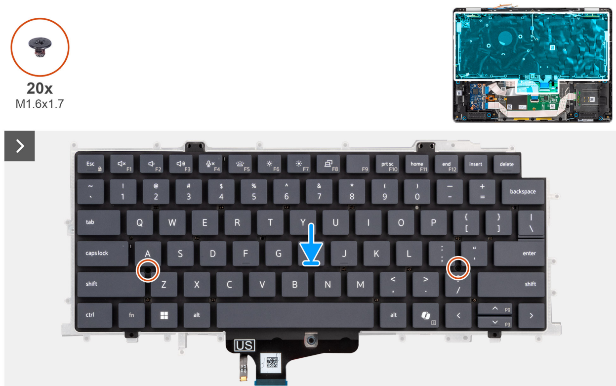
Figure 83. Installation du clavier
