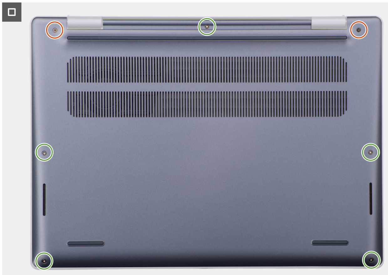
Figure 19. Installation du cache de fond
