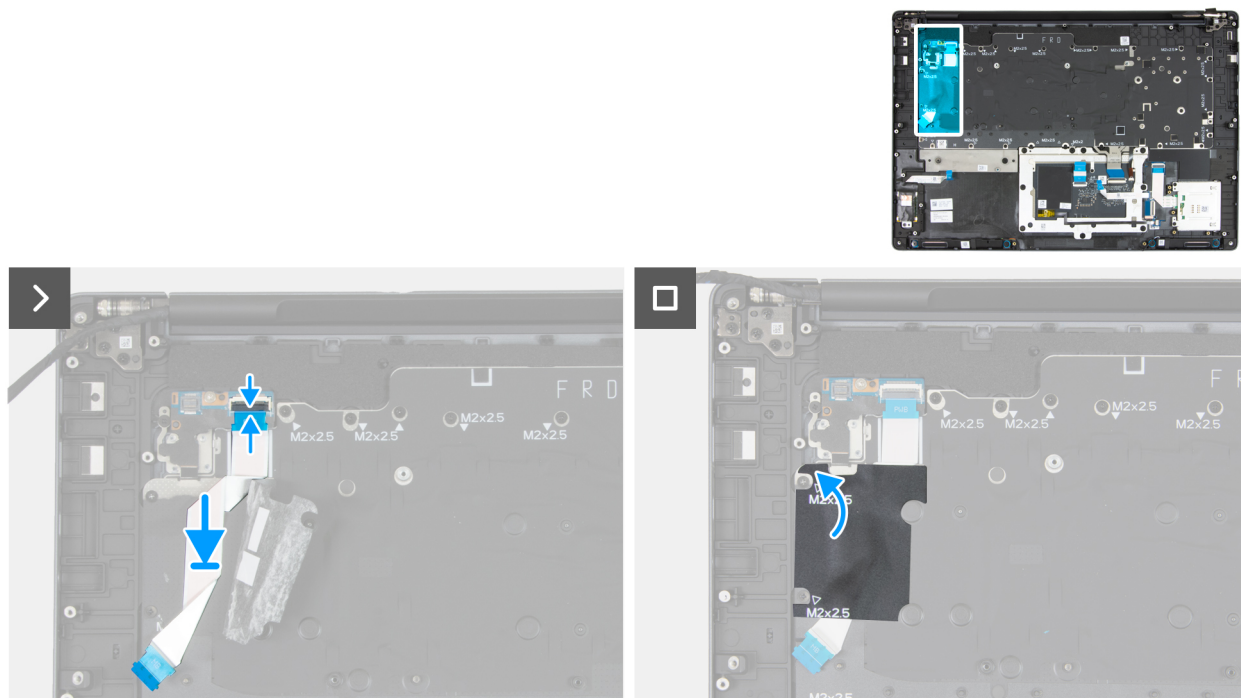
Abbildung 126. Einbauen des Kabels der Netzschalterplatine
