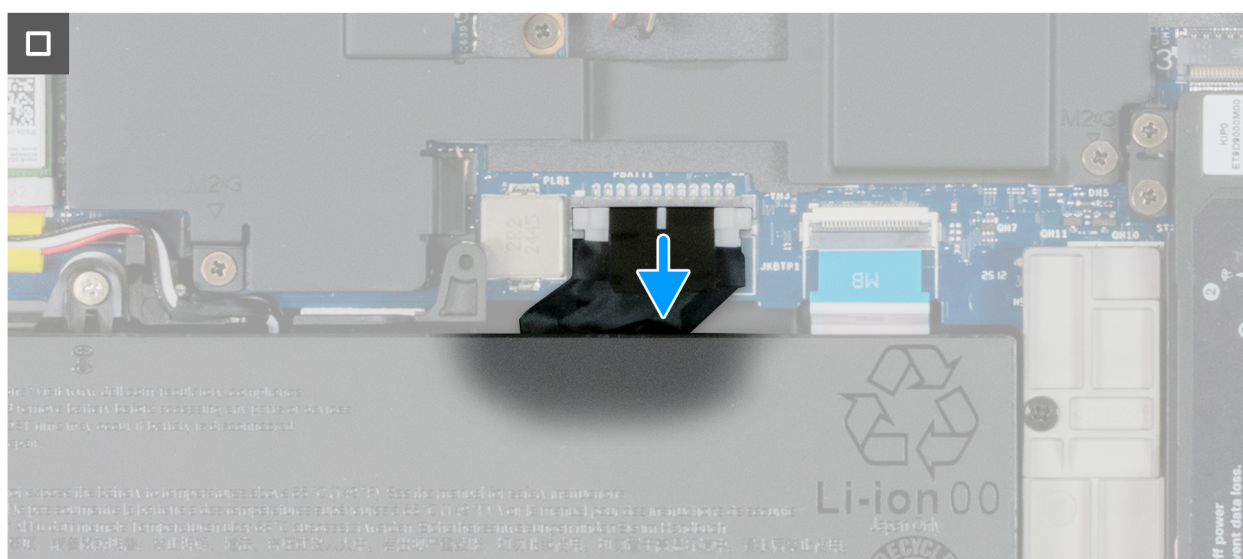
Afbeelding 26. De batterijkabel loskoppelen
