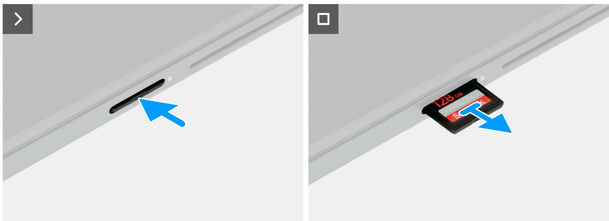
Afbeelding 10. De SD-kaart verwijderen
