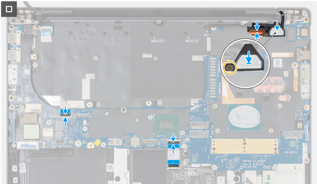
Afbeelding 116. De systeemkaart installeren
