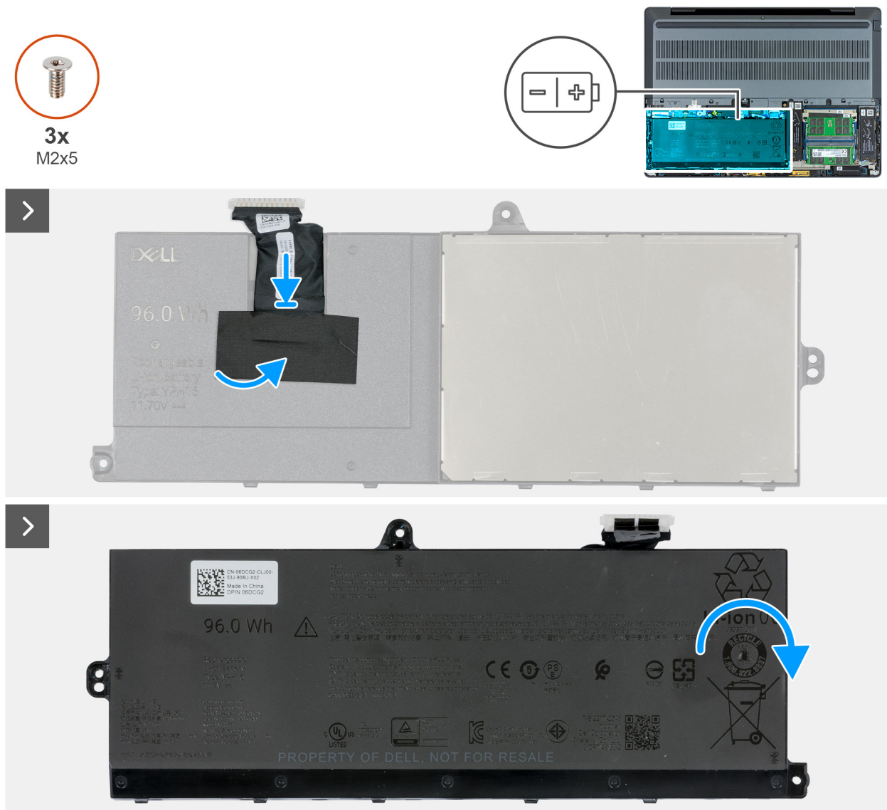
Afbeelding 44. De batterijkabel vervangen
