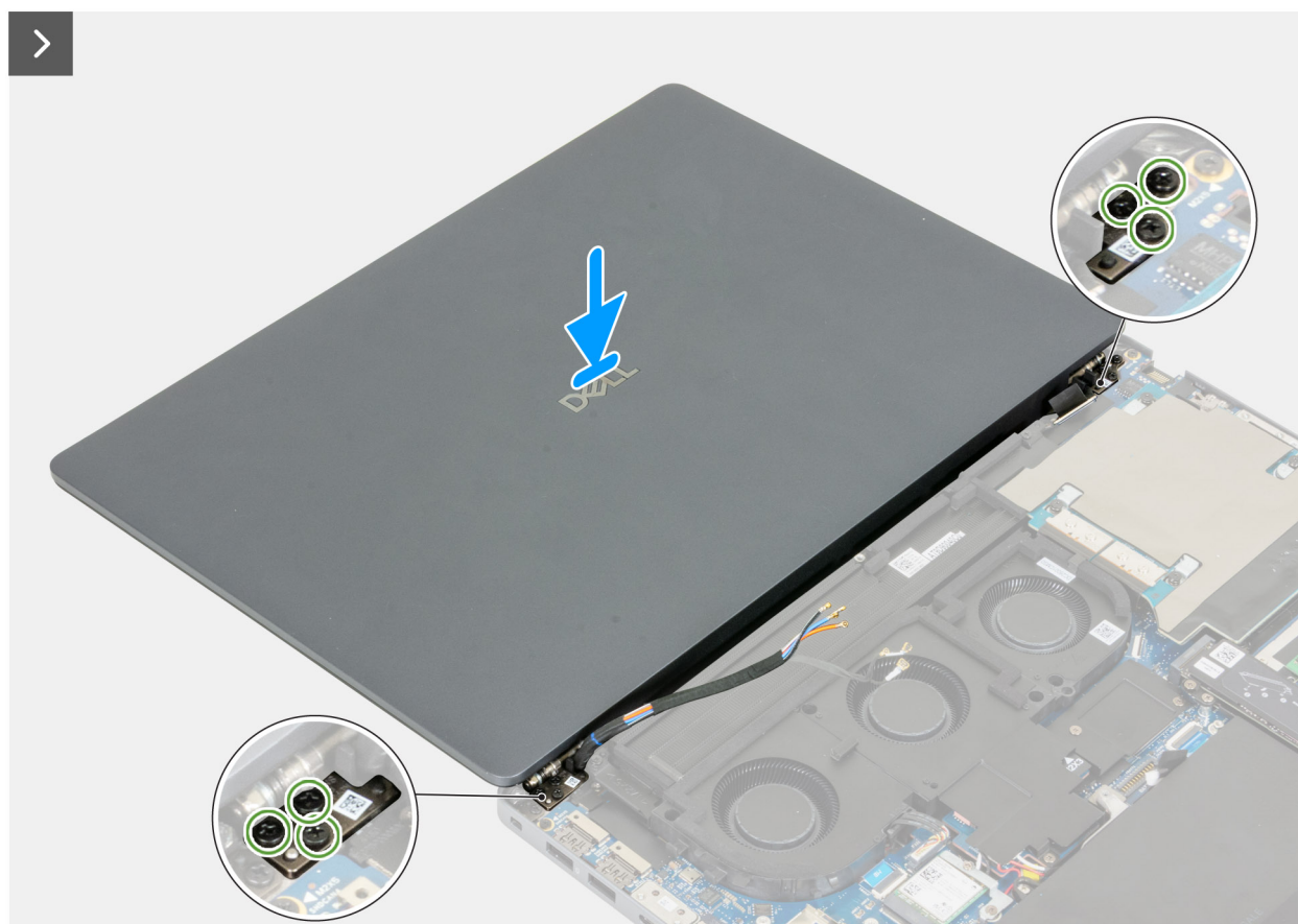
Afbeelding 65. De beeldscherm eenheid plaatsen
