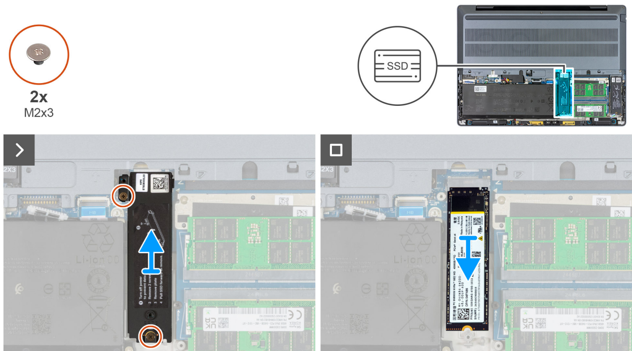
Afbeelding 38. De M.2 2280 SSD verwijderen uit slot 2 (SSD2)
