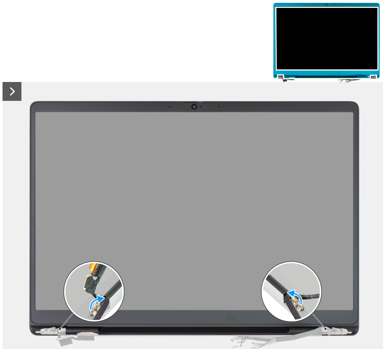
Afbeelding 83. De beeldschermbezel verwijderen
