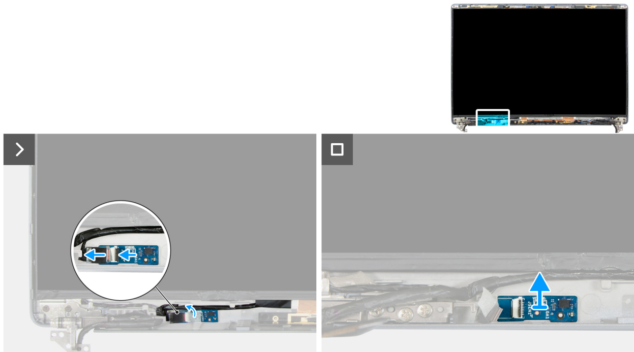
Afbeelding 101. De sensorkaart verwijderen
