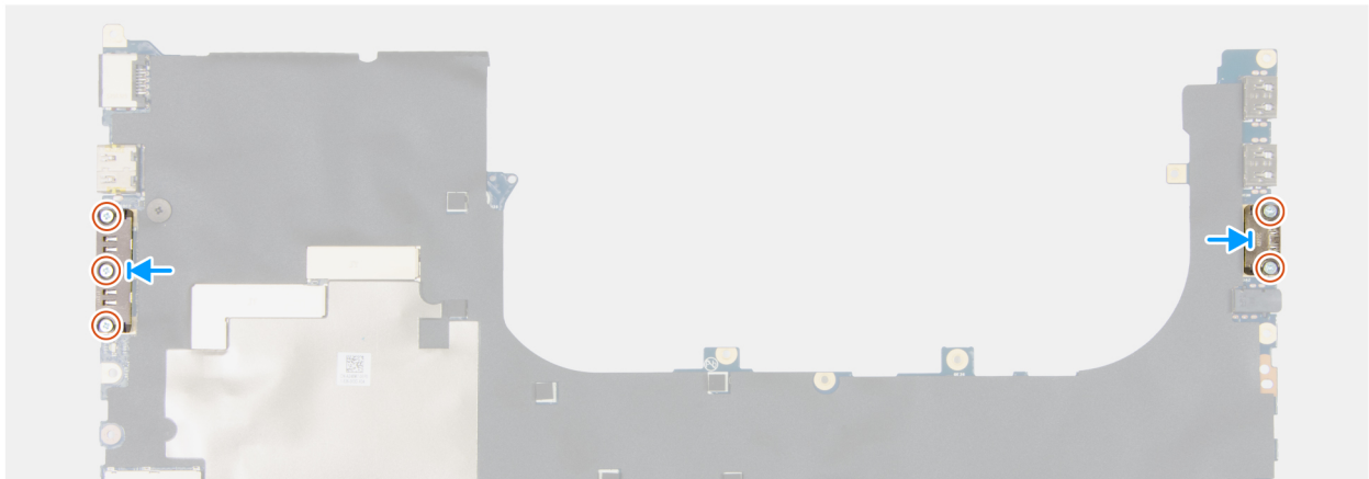
Afbeelding 118. De USB Type-C-connectormodule installeren
