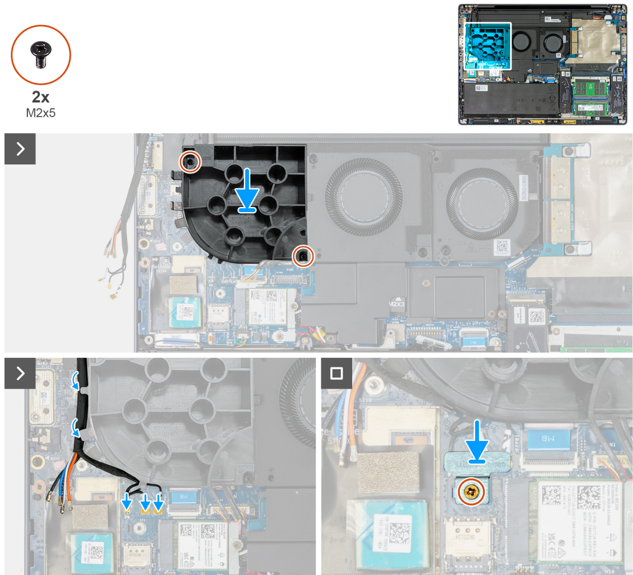
Afbeelding 60. De dummyventilator installeren
