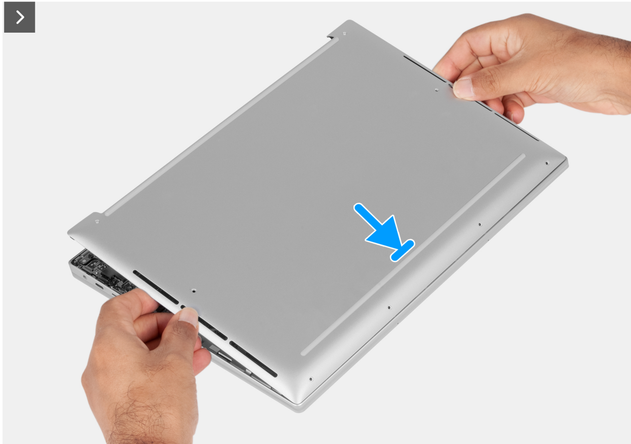
Abbildung 8. Anbringen der Bodenabdeckung
