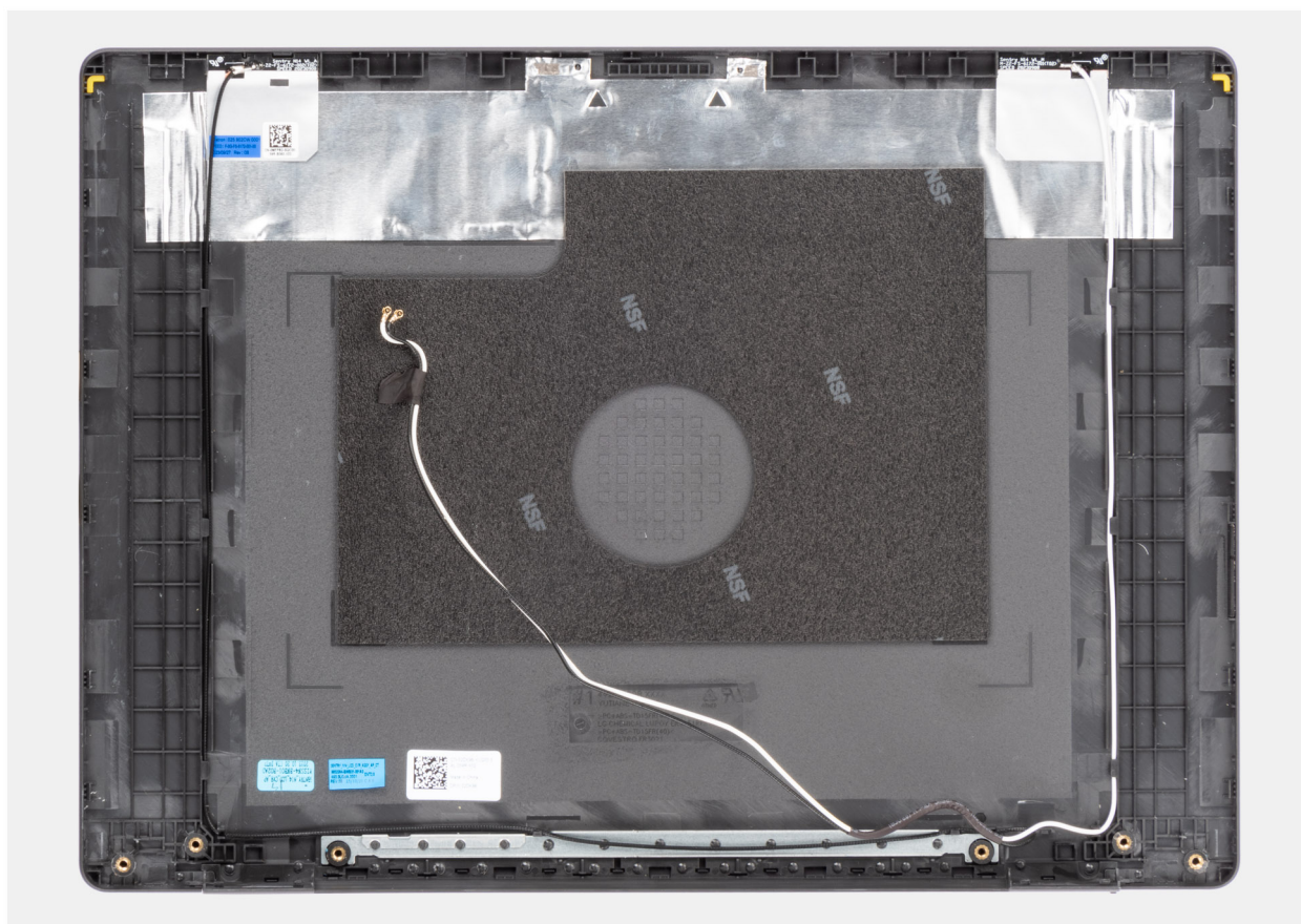
Afbeelding 90. Achterplaat van het beeldscherm en antenne-eenheid
