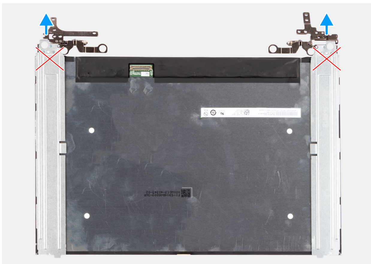
Afbeelding 80. Het beeldschermpaneel verwijderen
