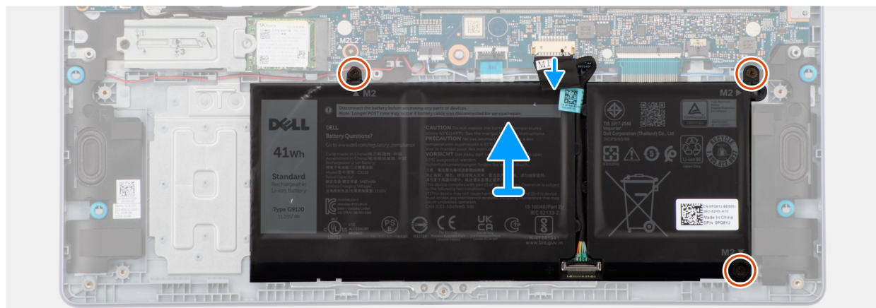
Afbeelding 20. De batterij verwijderen
