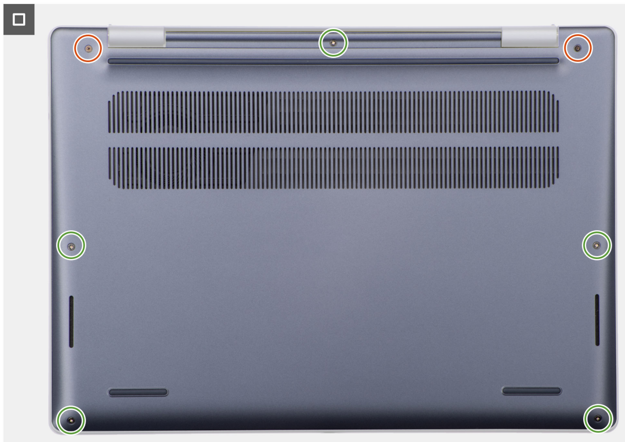
Afbeelding 19. De onderplaat installeren
