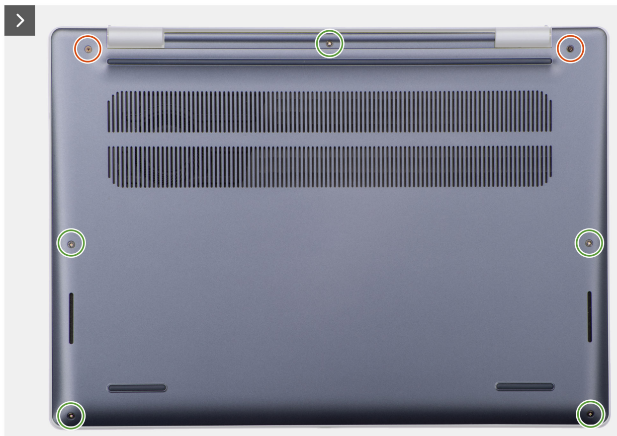
Afbeelding 16. De onderplaat verwijderen
