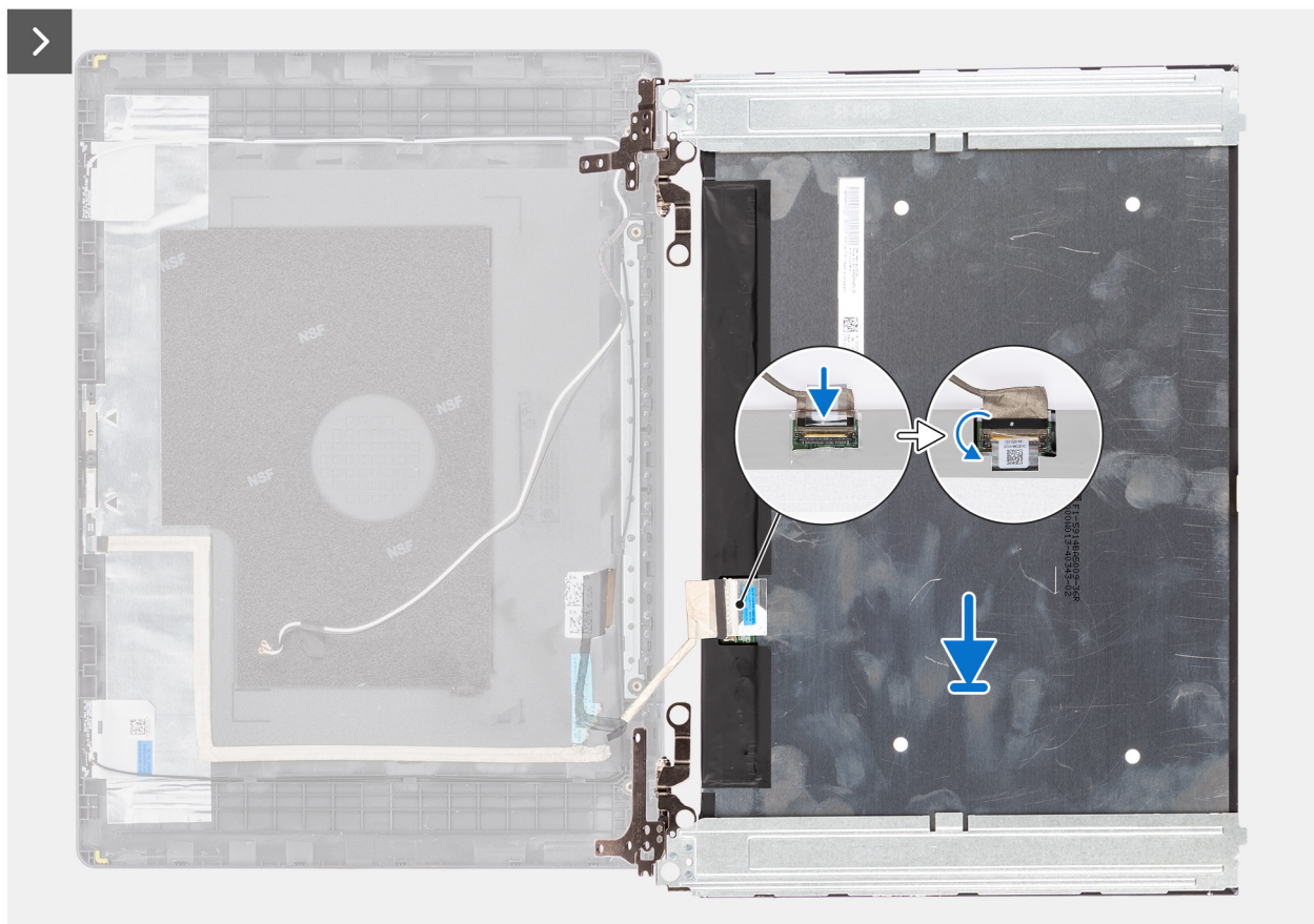
Afbeelding 81. Het beeldschermpaneel installeren
