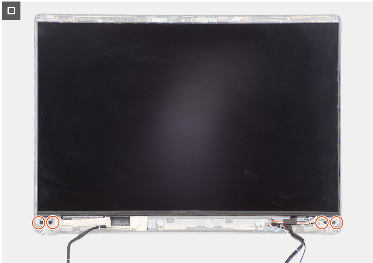
Ilustración 73. Instalación del panel de pantalla
