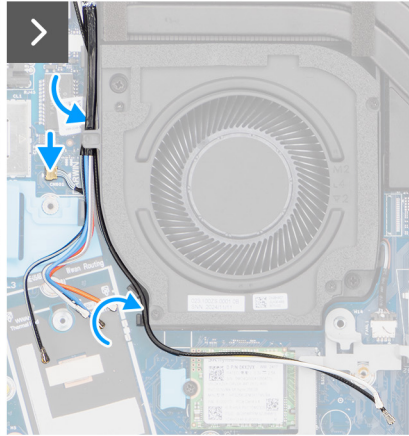
Ilustración 37. Instalación del ventilador derecho/del procesador
