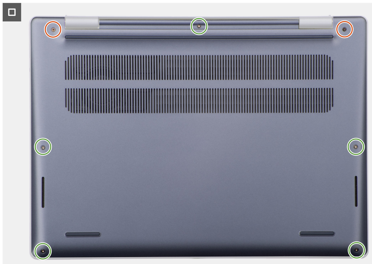
איור 19. התקנת כיסוי הבסיס
