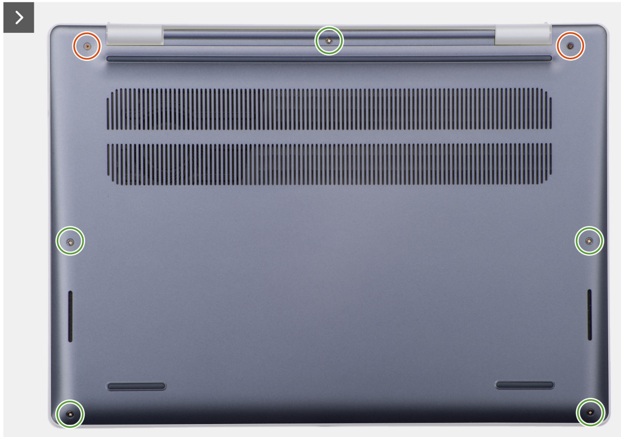
איור 16. הסרת כיסוי הבסיס
