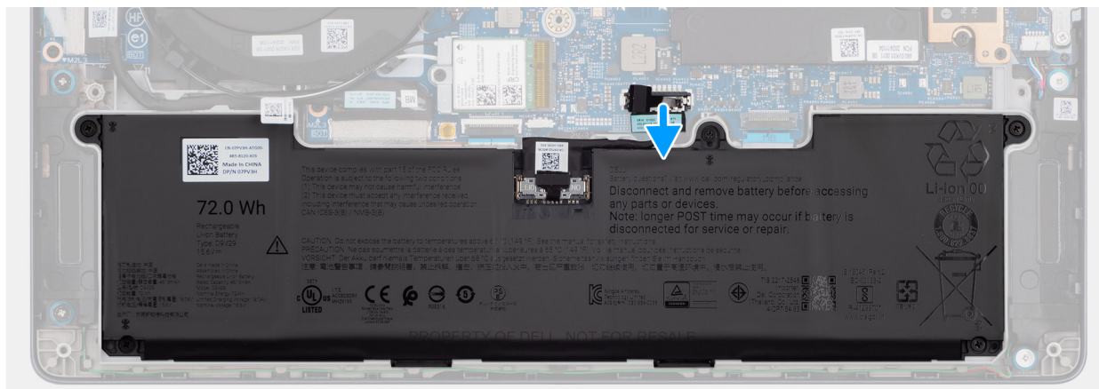
Figura13. Retirar o cabo da bateria
