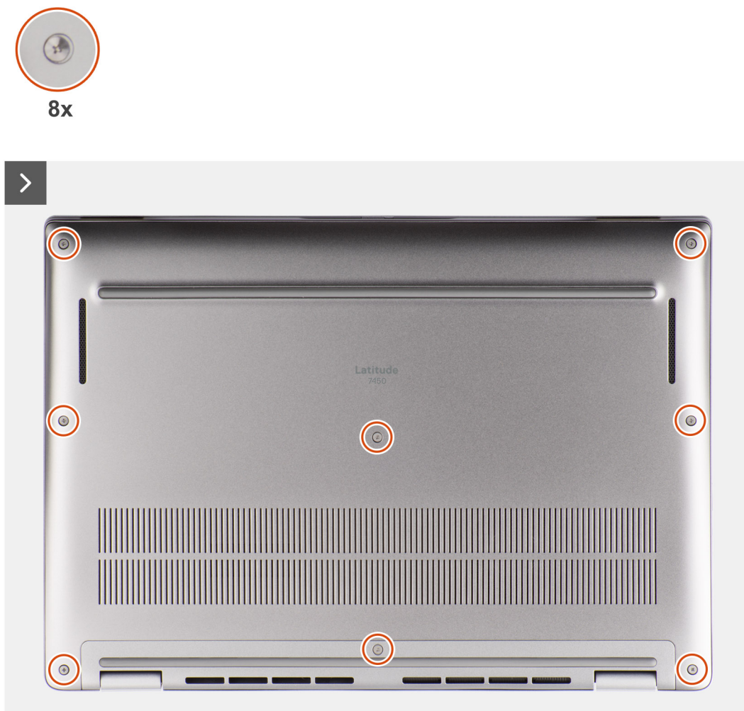
Ilustración 15. Extracción de la cubierta de la base
