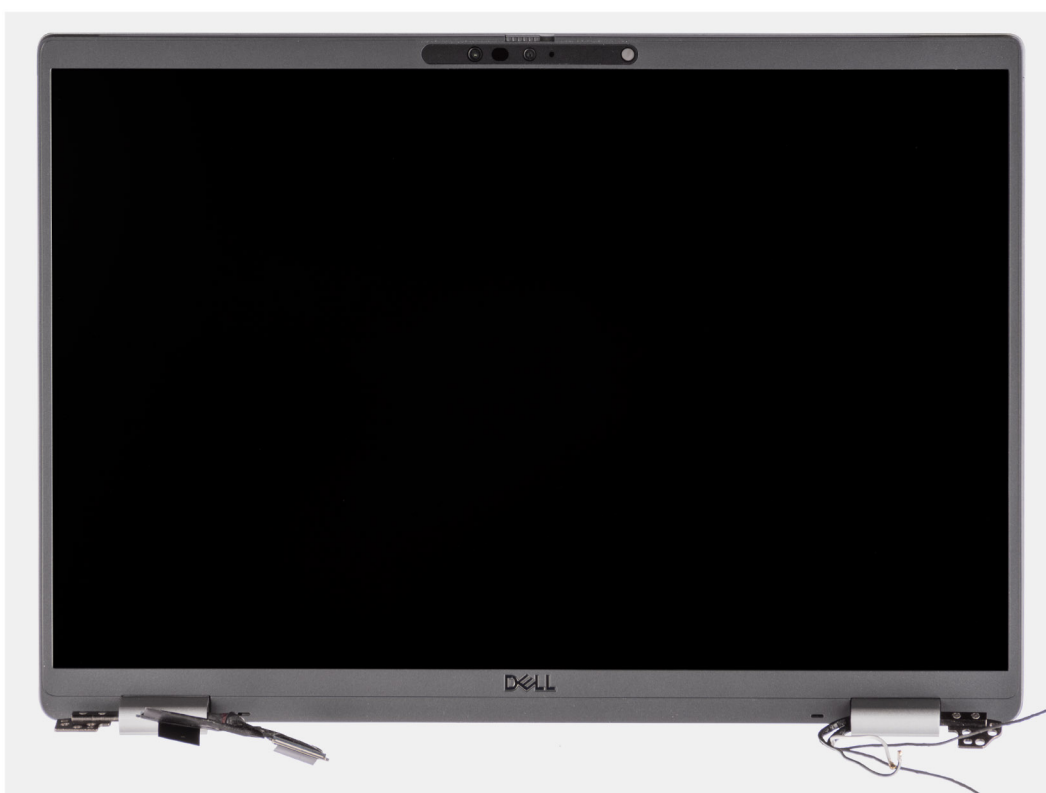
Ilustración 49. Ensamblaje de la pantalla con cables de la antena WWAN
