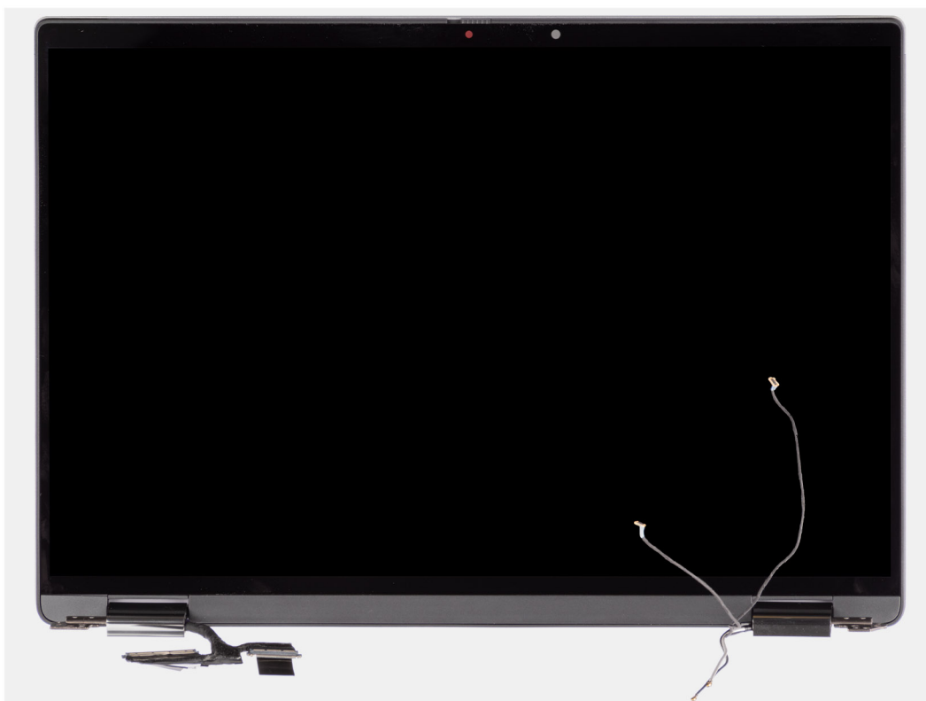
Ilustración 48. Ensamblaje de la pantalla con cables de la antena WWAN
