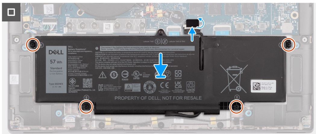
Ilustración 40. Instalación de la batería de 3 celdas
