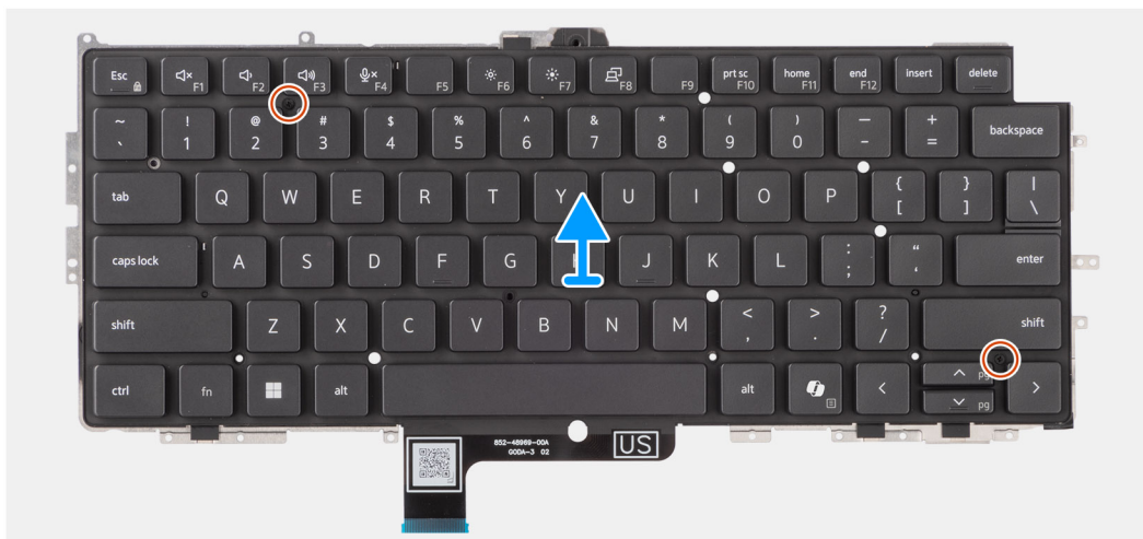
Ilustración 76. Extracción del teclado
