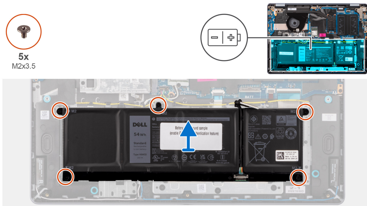
Rysunek 15. Wymontowywanie akumulatorów
