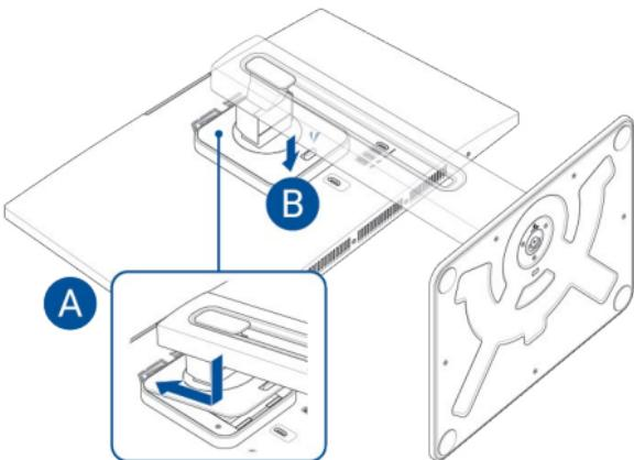
Schieben Sie die Verriegelung in die abgebildete Ausrichtung und entfernen Sie dann den Ständer. Anschließend können Sie Ihren ASUS All-in-One PC an einem für VESA-Halterungen kompatiblen Gerät installieren.
