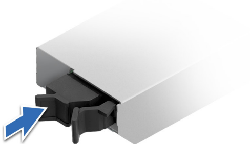
Abbildung 182. Installieren des BOSS-N1-Kartenträgerplatzhalters
