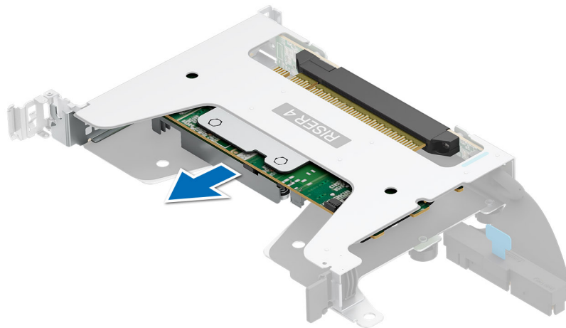
Abbildung 151. Entfernen der Erweiterungskarte mit flachem Profil aus Riser 4b
