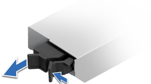
Abbildung 214. Entfernen des Platzhalters für den BOSS-N1-DC-MHS-Kartenträger
