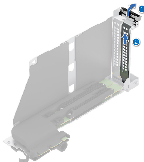
Abbildung 170. Entfernen des Abdeckblechs
