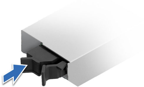
Abbildung 215. Installieren des Platzhalters für den BOSS-N1-DC-MHS-Kartenträger
