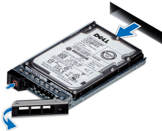
Abbildung 60. Entfernen eines verkabelten 3,5-Zoll-Laufwerksträgers
