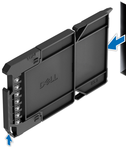
Abbildung 60. Entfernen eines Platzhalters für ein EDSFF E3.S-Laufwerk
