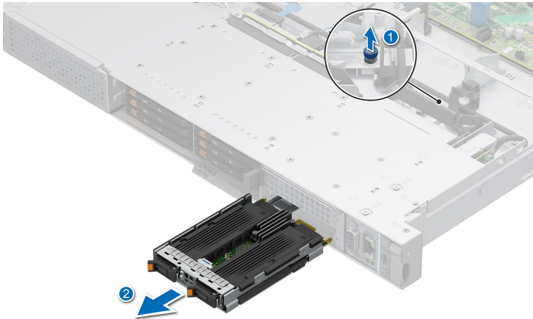
Abbildung 187. Entfernen des BOSS-N1 DC-MHS-Modulfachs aus dem System
