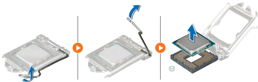
Ilustración 59. Extracción del procesador
