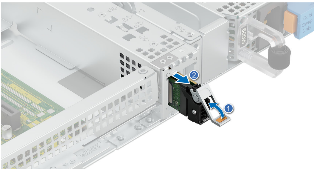
Ilustración 73. Extracción del módulo M.2 de BOSS-N1
