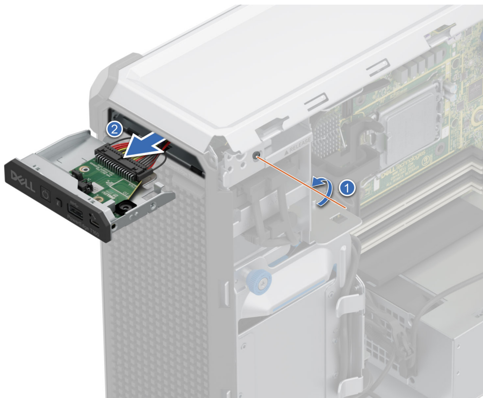
Figure 68. Retrait du bâti du panneau de commandes
