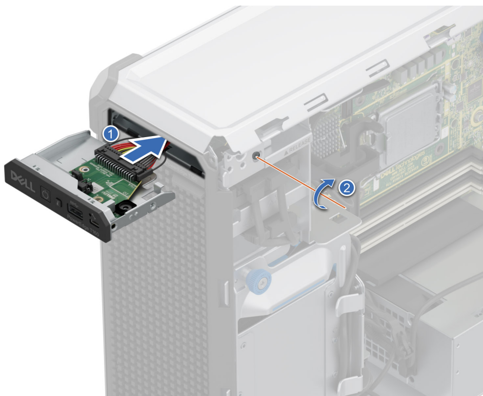
Figure 71. Installation du bâti du panneau de commandes
