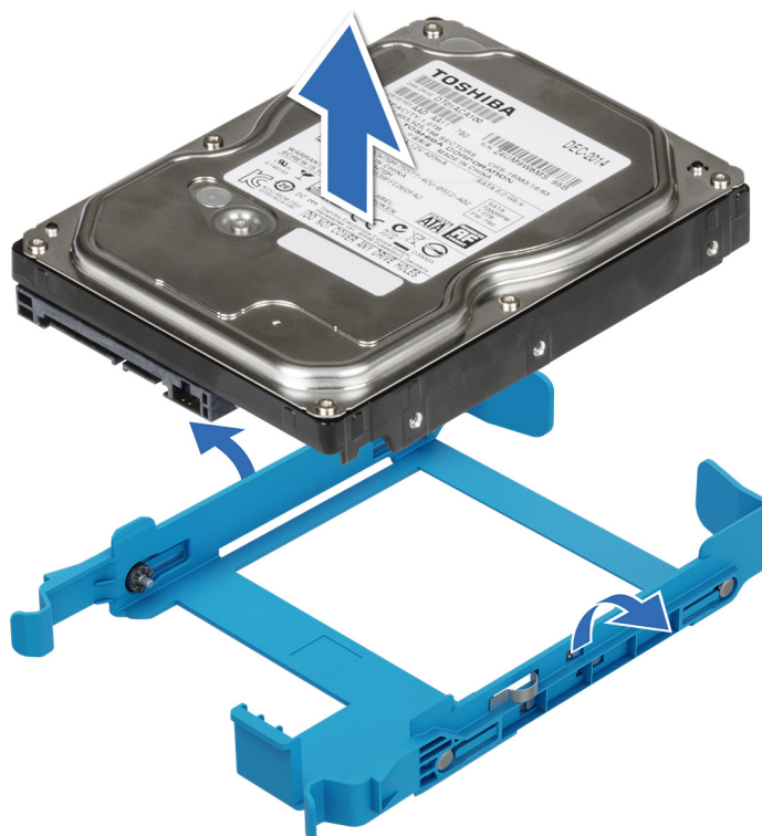
Figure 26. Retrait d'un disque dur installé de son support
