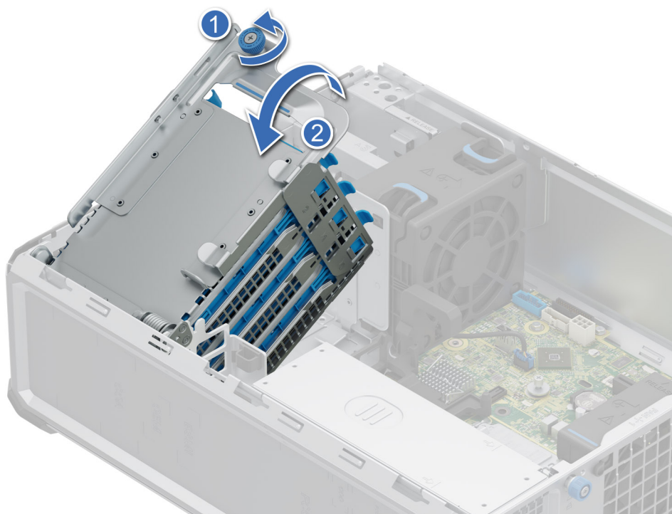
Figure 20. Retrait d'un disque dur du bâti de disques durs
