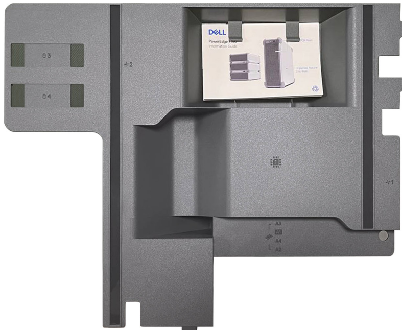
Figure 8. Carénage d'aération avec consignes de sécurité
