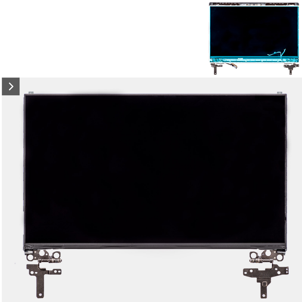
Abbildung 59. Einbauen des Bildschirms
