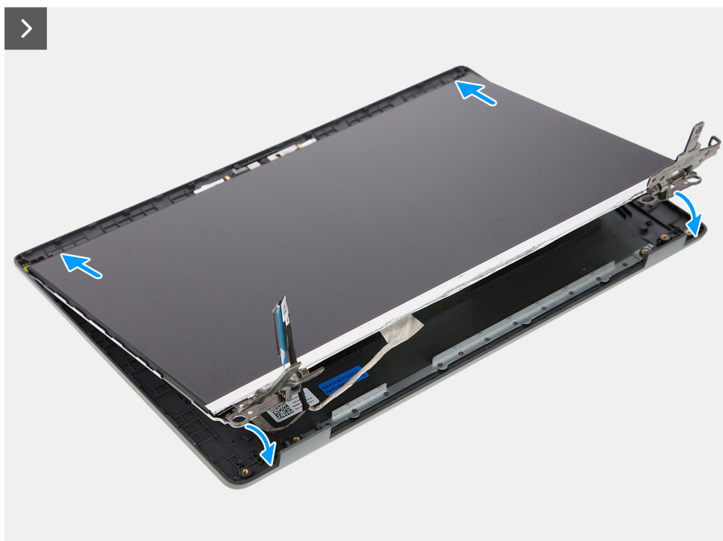
Abbildung 61. Einbauen des Bildschirms
