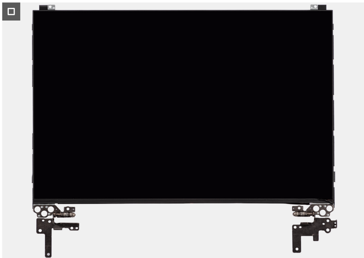
Figure 77. Retrait de l'assemblage du panneau d'écran
