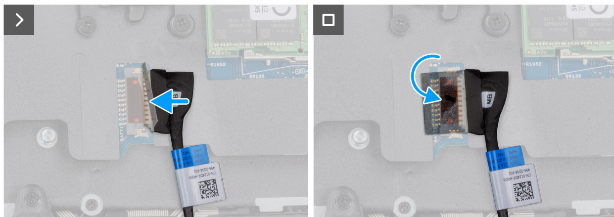
Figure 14. Connexion du câble de la batterie
