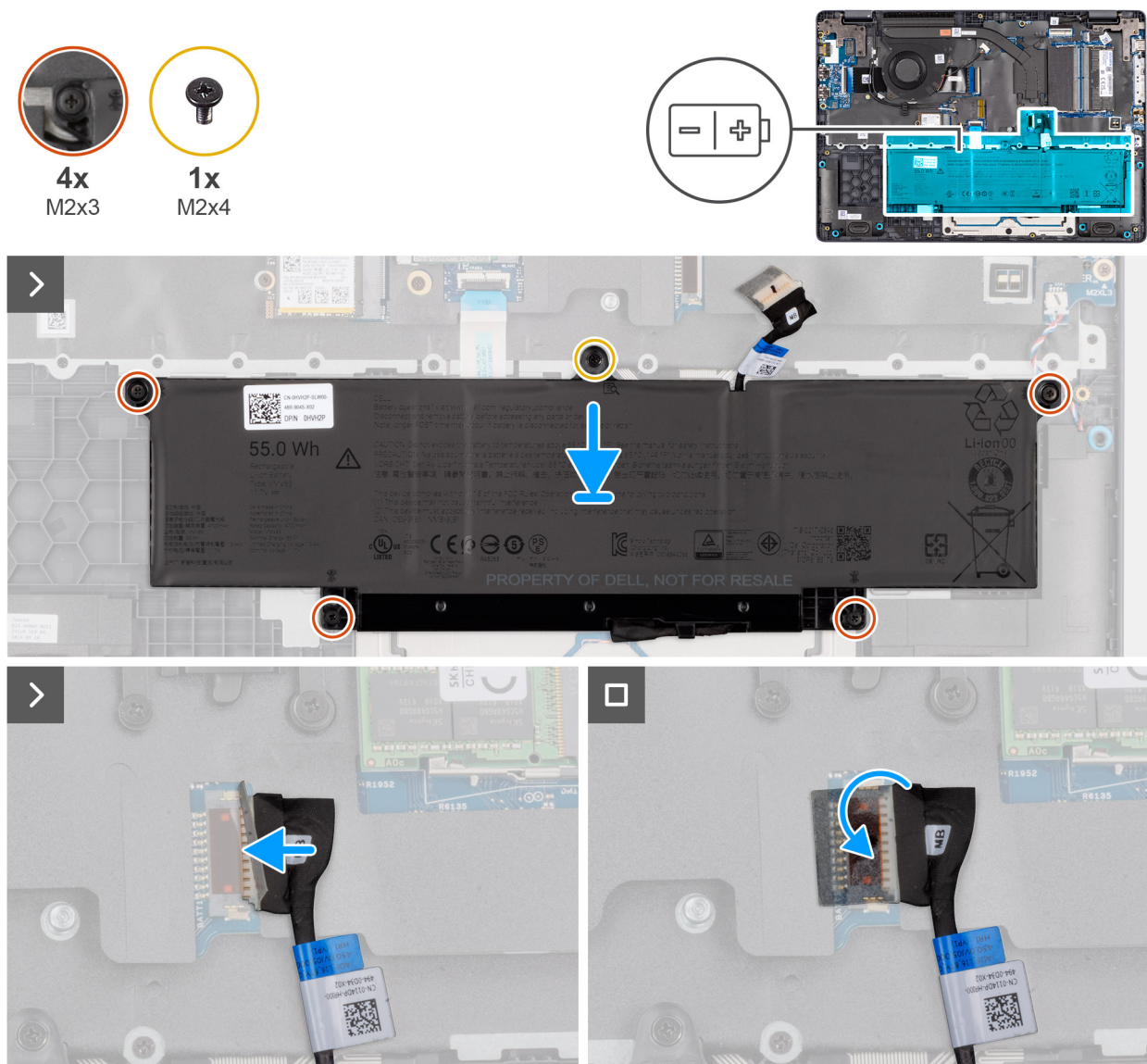
Afbeelding 18. De batterij installeren
