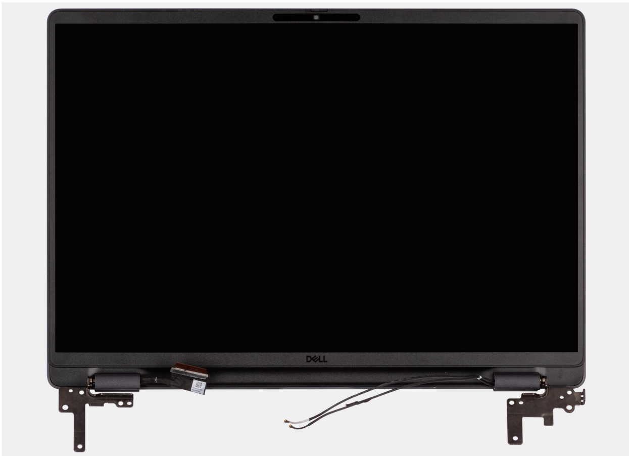
Afbeelding 64. De beeldschermeenheid verwijderen
