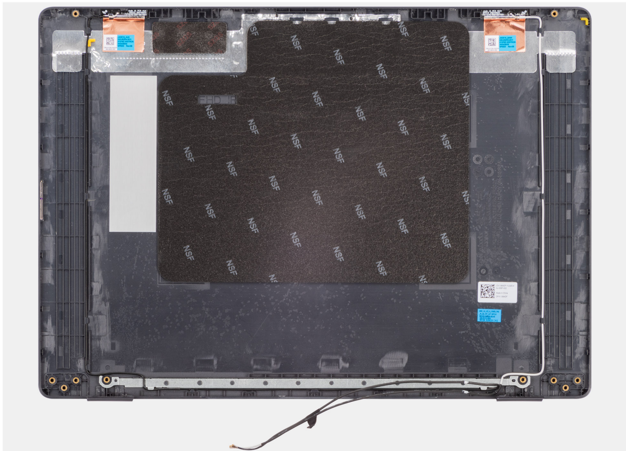
Afbeelding 86. Het achterpaneel van de beeldschermeenheid verwijderen
