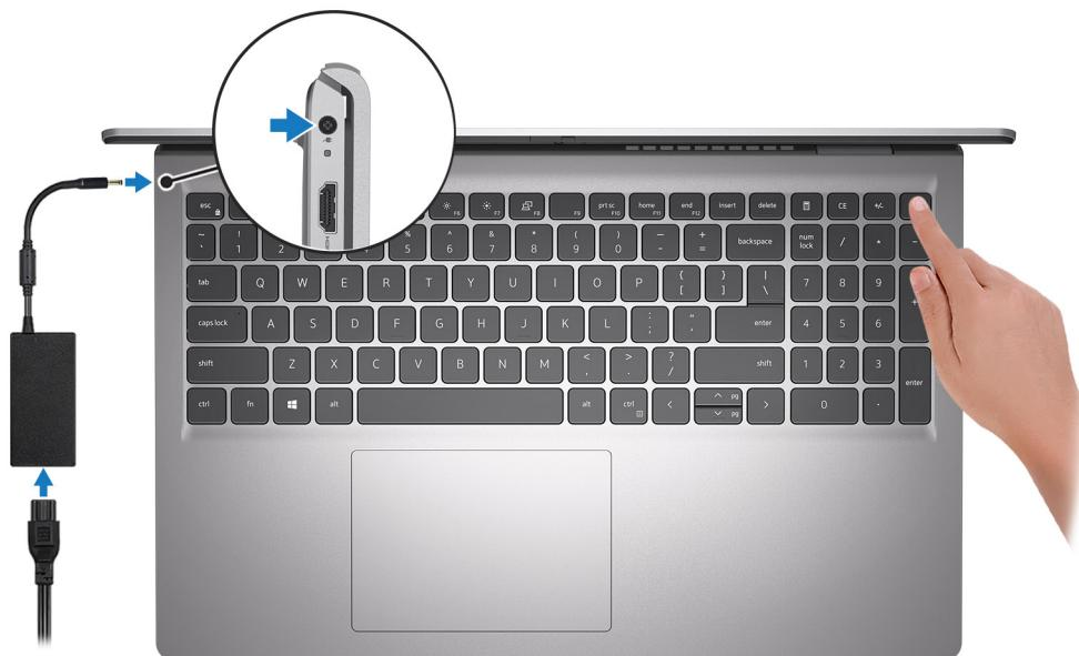
**NOTA:** La batería puede entrar en modo de ahorro de energía durante el envío para conservar la carga. Asegúrese de que el adaptador de alimentación esté conectado a la computadora cuando se enciende por primera vez.
