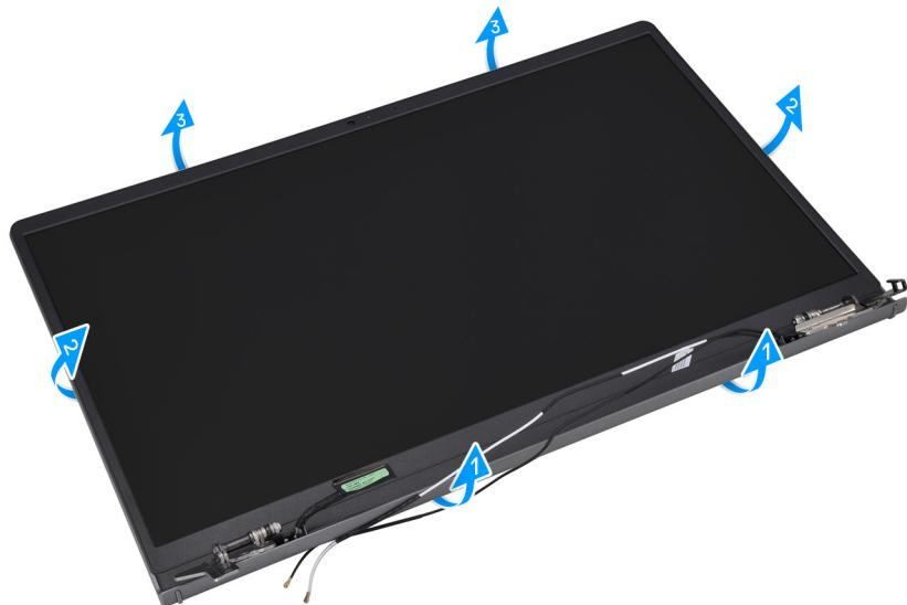
4. Levante y extraiga el bisel de la pantalla del ensamblaje de la pantalla.
