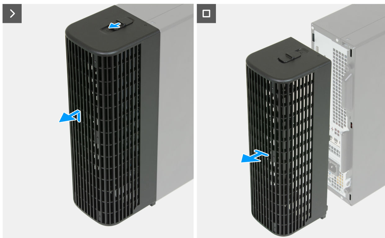
Ilustración 4. Extracción de la cubierta de cables
