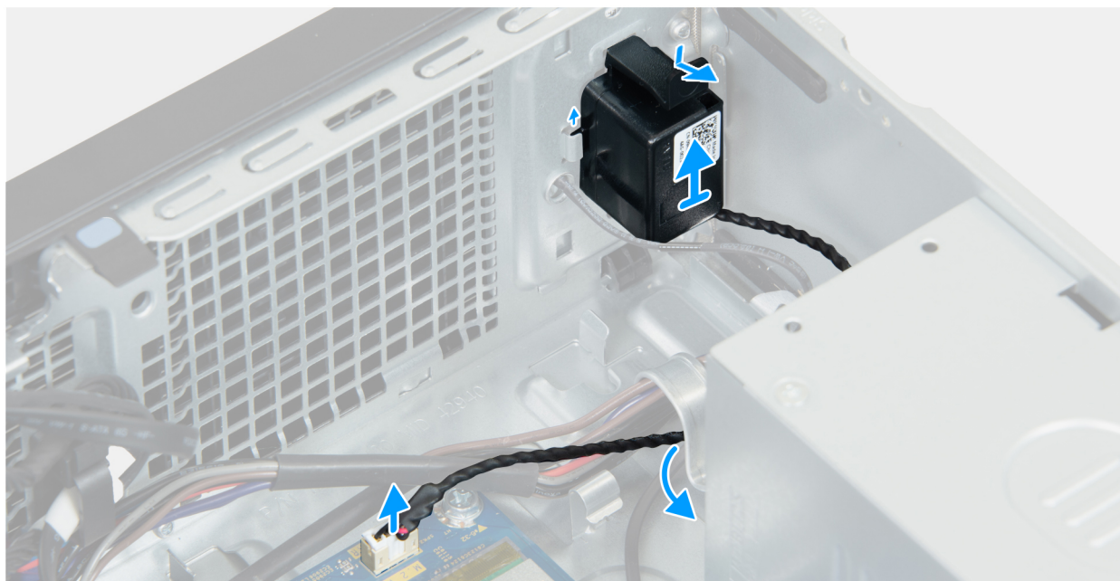
Ilustración 18. Extracción del altavoz interno
