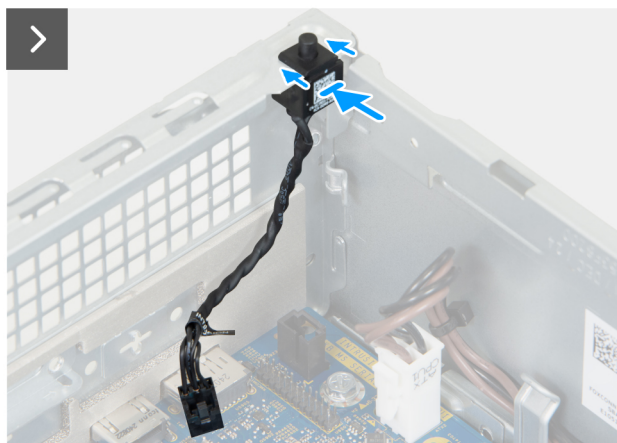
Ilustración 43. Instalación del switch de intrusión
