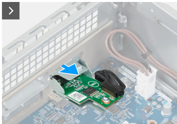
Ilustración 57. Extracción del módulo de puerto serial
