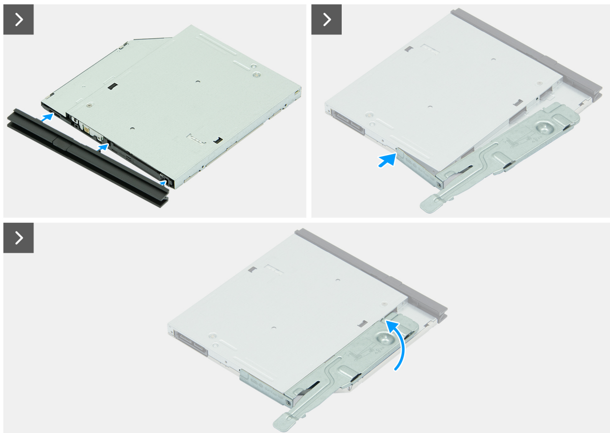
Ilustración 33. Instalación de la unidad óptica
