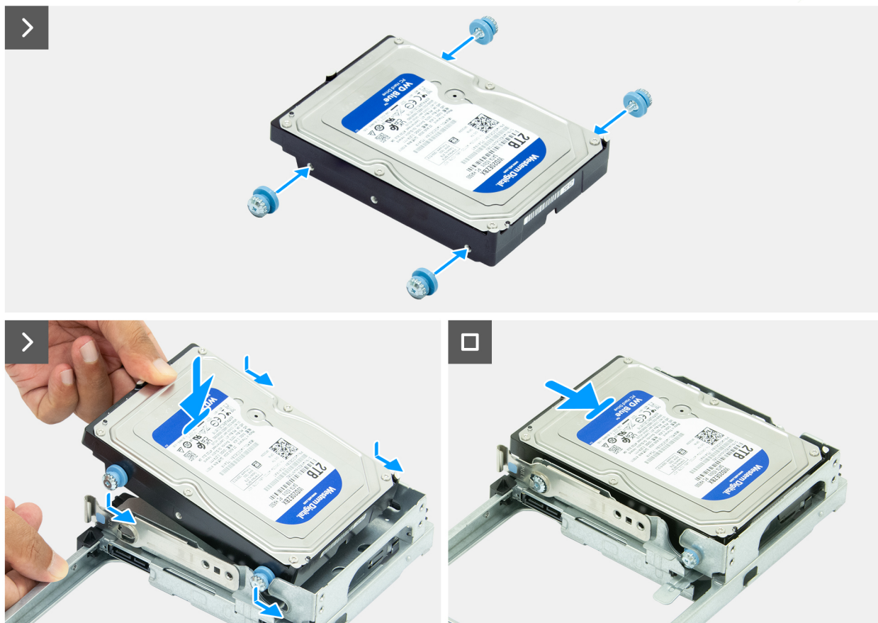
Ilustración 41. Instalación del disco duro
