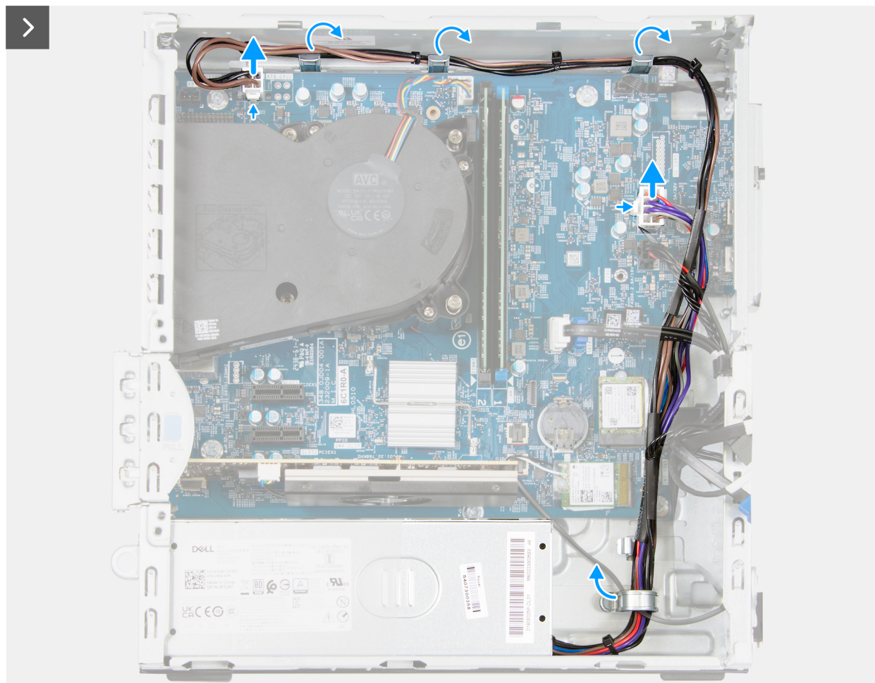
Ilustración 48. Extracción de la fuente de alimentación
