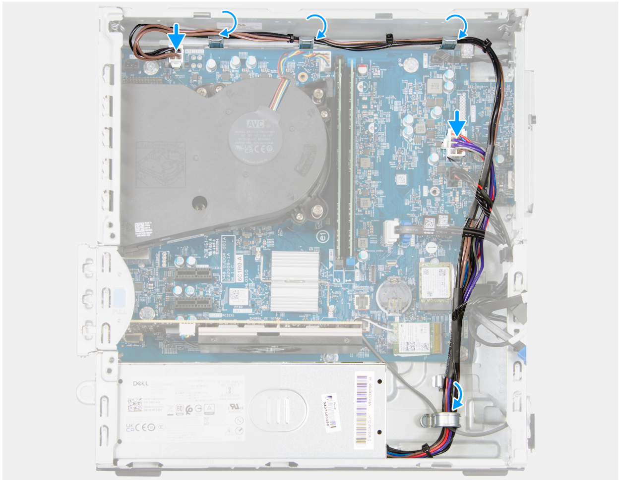
Ilustración 51. Instalación de la fuente de alimentación
