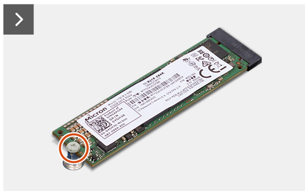
Ilustración 24. Extracción de la unidad de estado sólido M.2 2280
