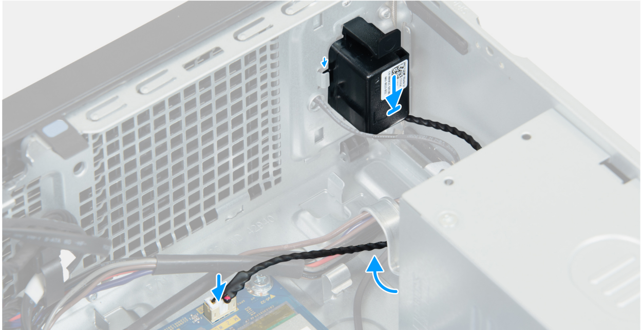
Ilustración 19. Instalación del altavoz interno
