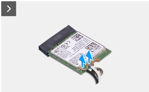
Ilustración 29. Extracción de la tarjeta inalámbrica
