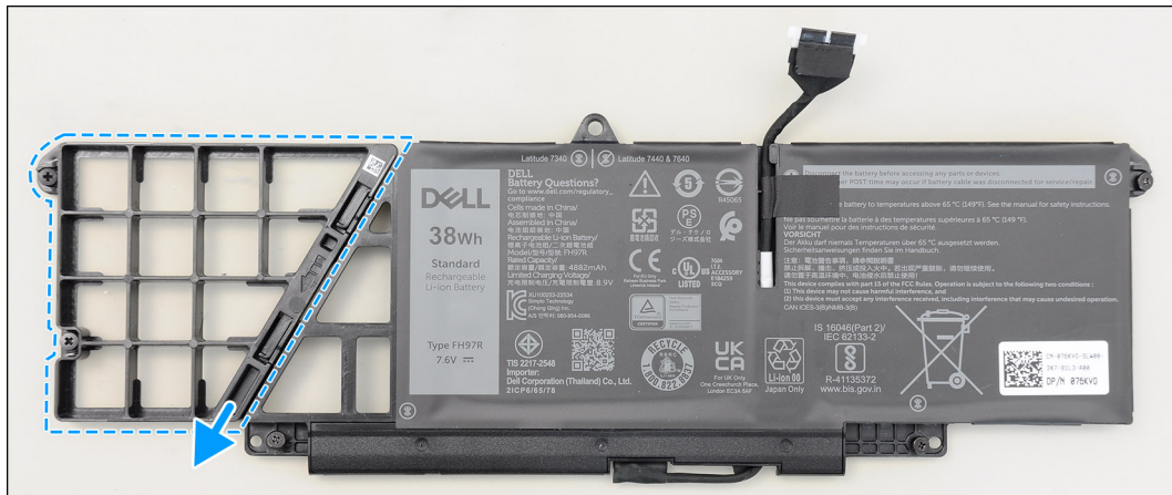
Afbeelding 35. De 2-cels batterij verwijderen
