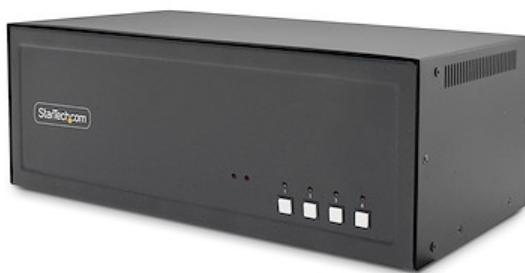
Gestisci più sistemi sicuri da una singola postazione con lo switch KVM certificato NIAP per quattro monitor, che offre sicurezza senza compromessi, prestazioni affidabili di livello professionale e controllo fluido su un massimo di quattro computer con quattro display 4K a 30Hz.
