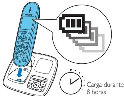
Coloque el microteléfono en la estación base para cargarlo. Cuando el microteléfono esté colocado correctamente en la estación base, oírán un pitido.
