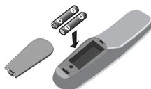
Вставьте в пульт дистанционного управления 2 батарейки типа АА, которые поставляются вместе с телевизором. Батарейки должны были установлены с правильной полярностью.
