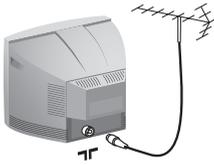
Stecken Sie den Stecker des Antennenkabels in die auf der Rückseite des Fernsehgeräts befindliche Antennenbuchse (☐).
