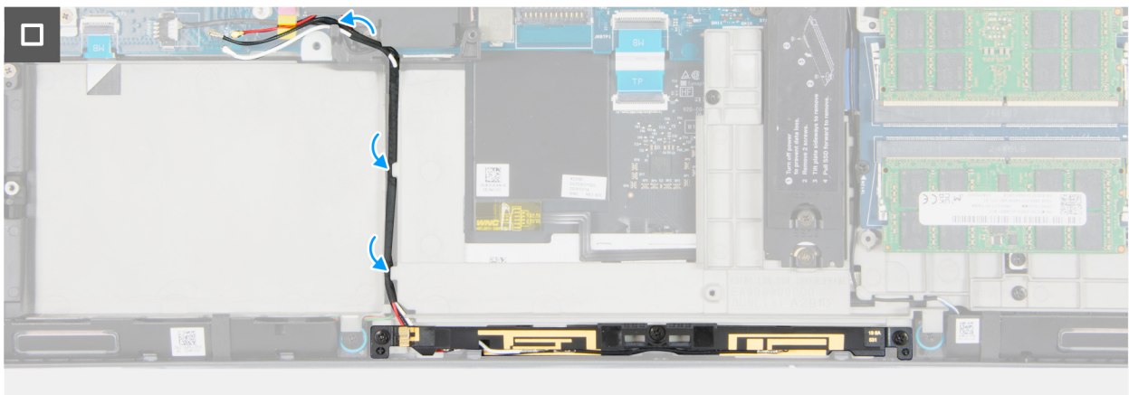
Ilustración 78. Instalación del módulo de la antena WLAN
