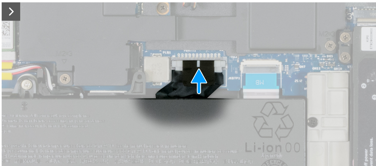
Ilustración 27. Conexión del cable de la batería
