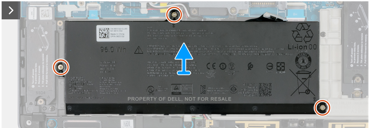
Ilustración 44. Extracción de la batería
