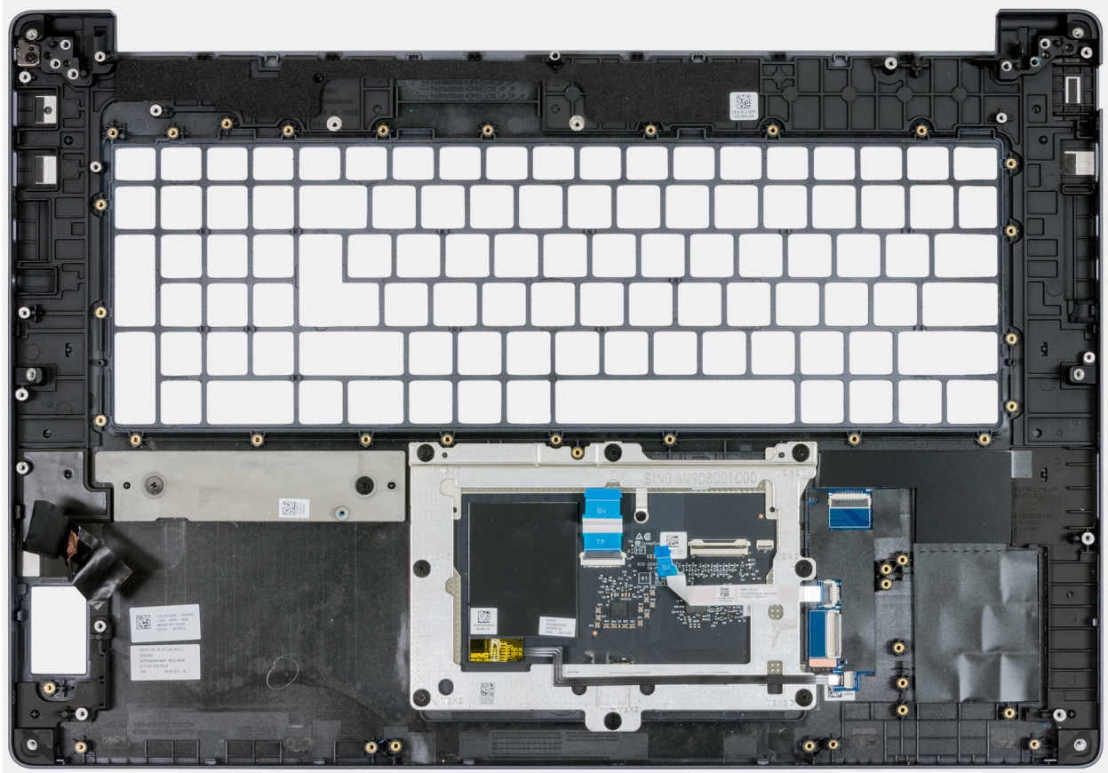
Ilustración 130. Ensamblaje del reposamanos
