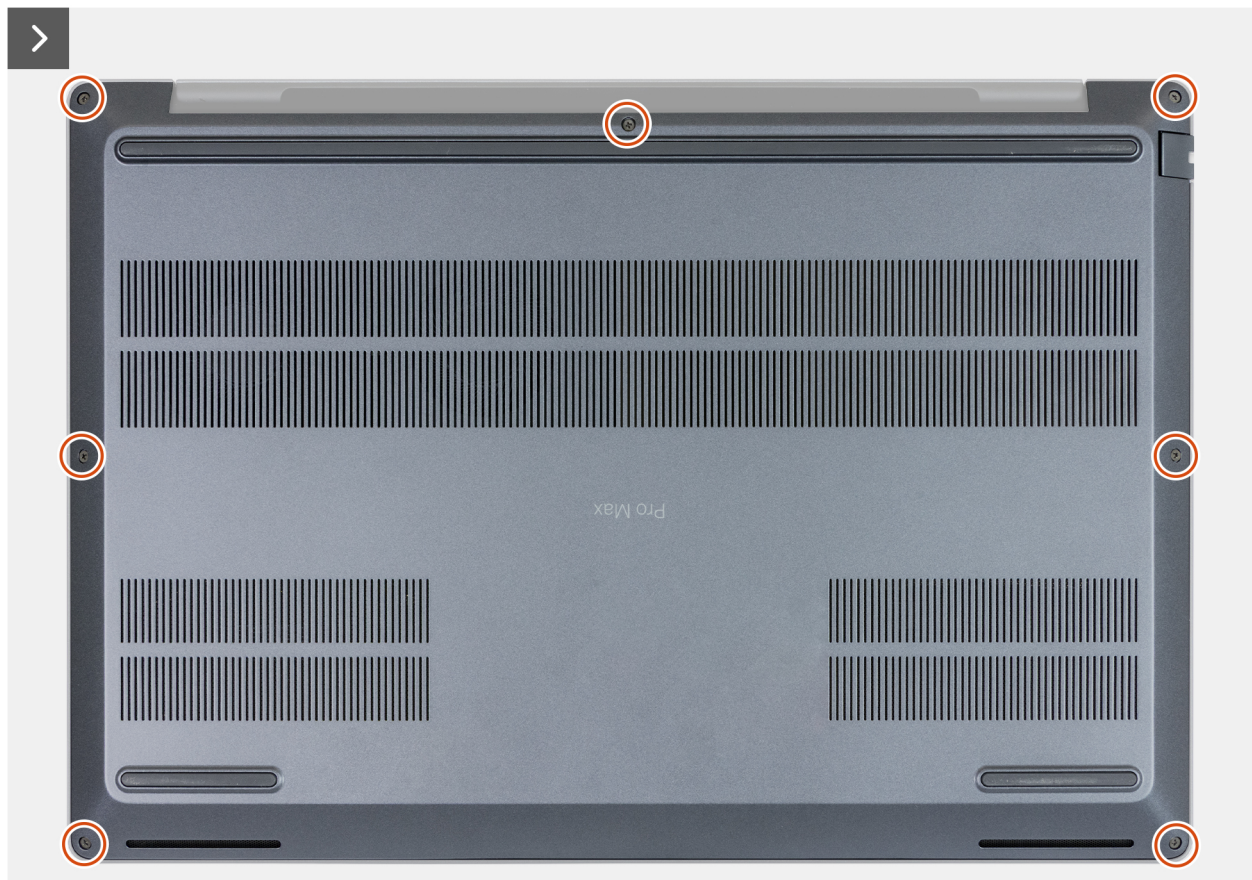
Ilustración 24. Cómo aflojar los tornillos cautivos
