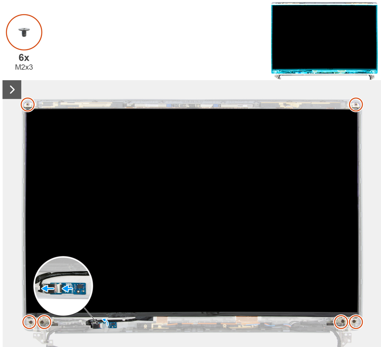
Ilustración 95. Extracción del panel de pantalla
