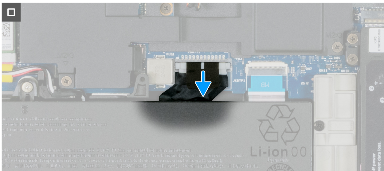
Ilustración 26. Desconexión del cable de la batería
