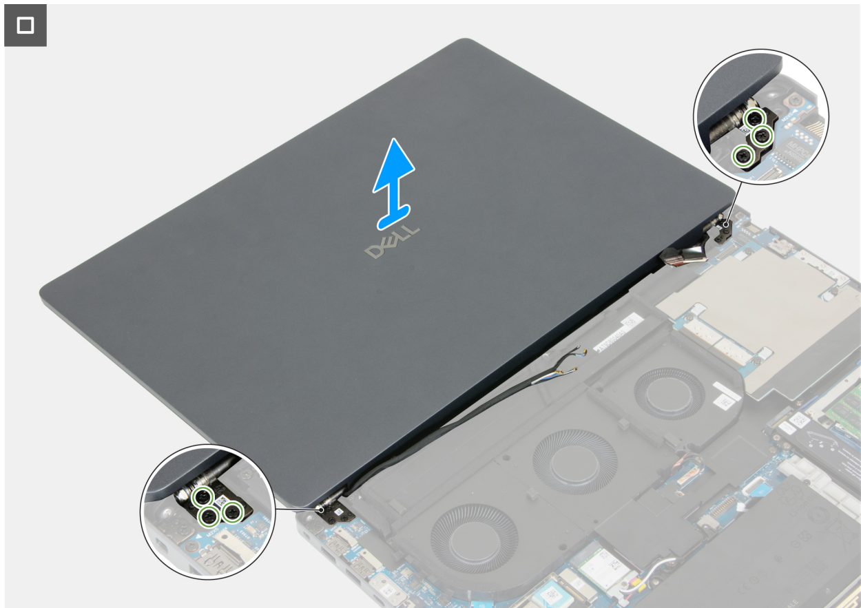
Ilustración 64. Extracción del ensamblaje de la pantalla
