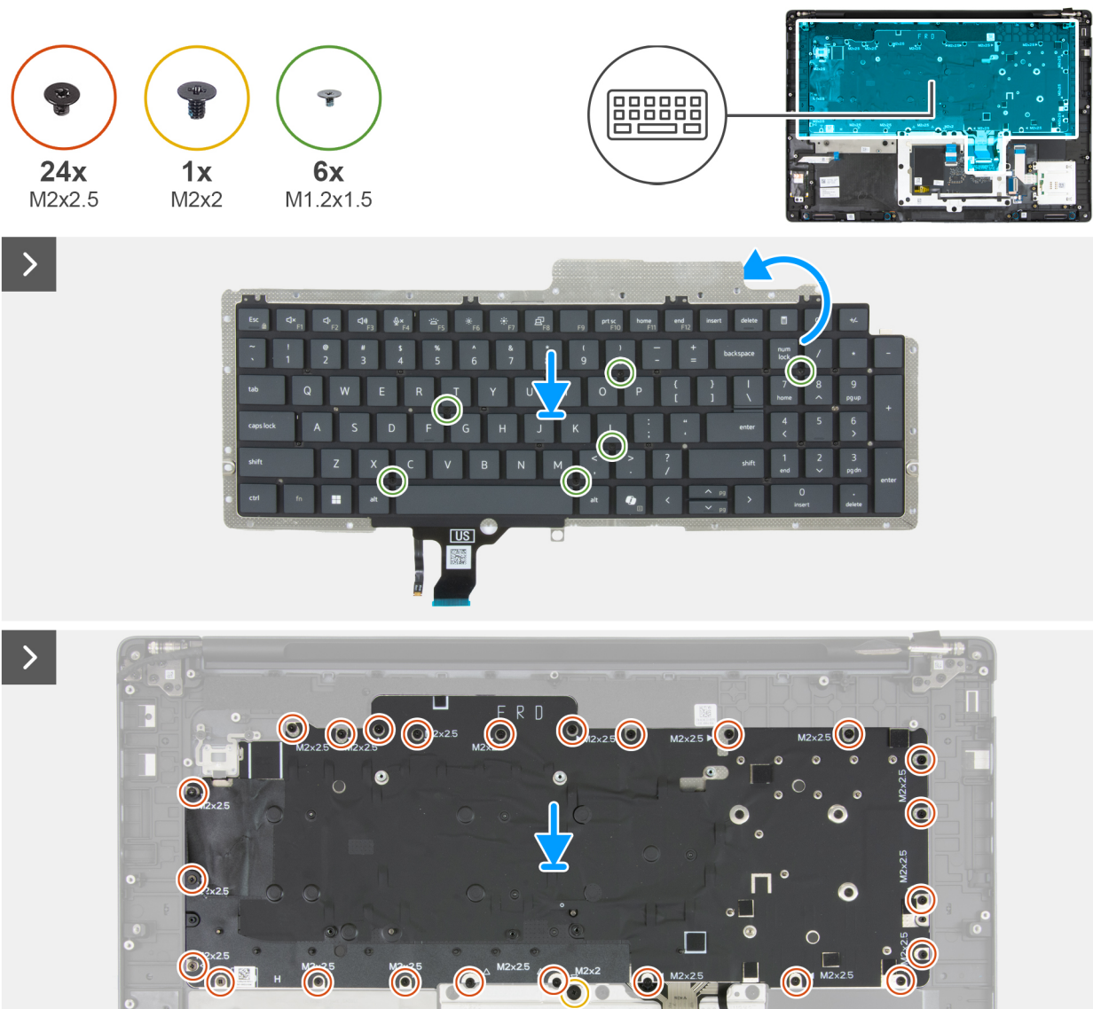
Ilustración 119. Instalación del teclado
