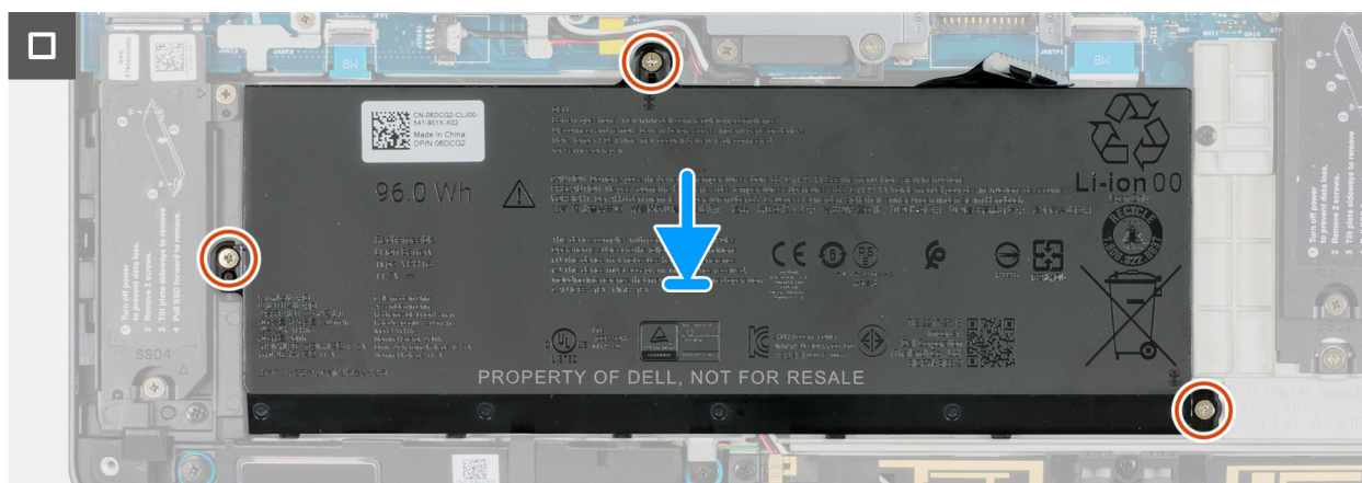
Ilustración 47. Colocación de la batería
