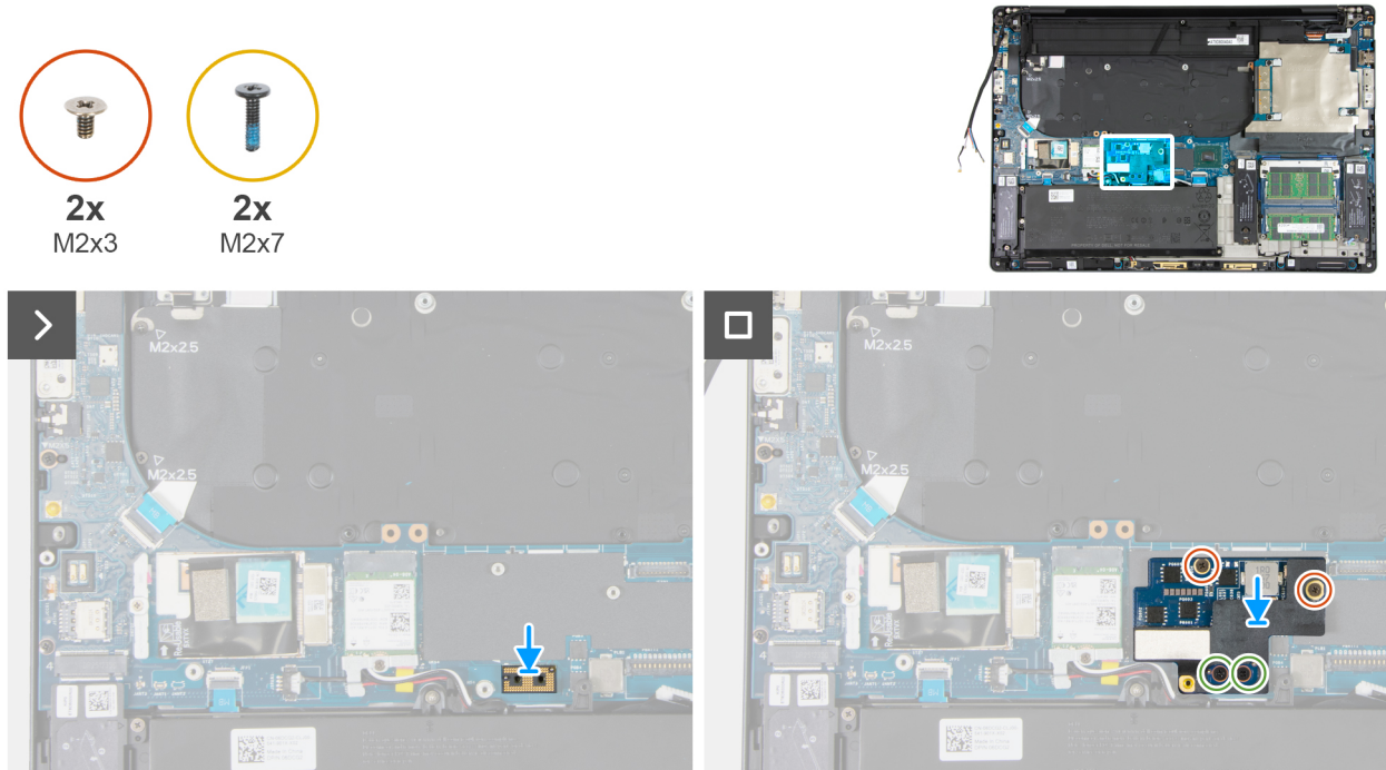
Ilustración 72. Instalación de la placa de alimentación
