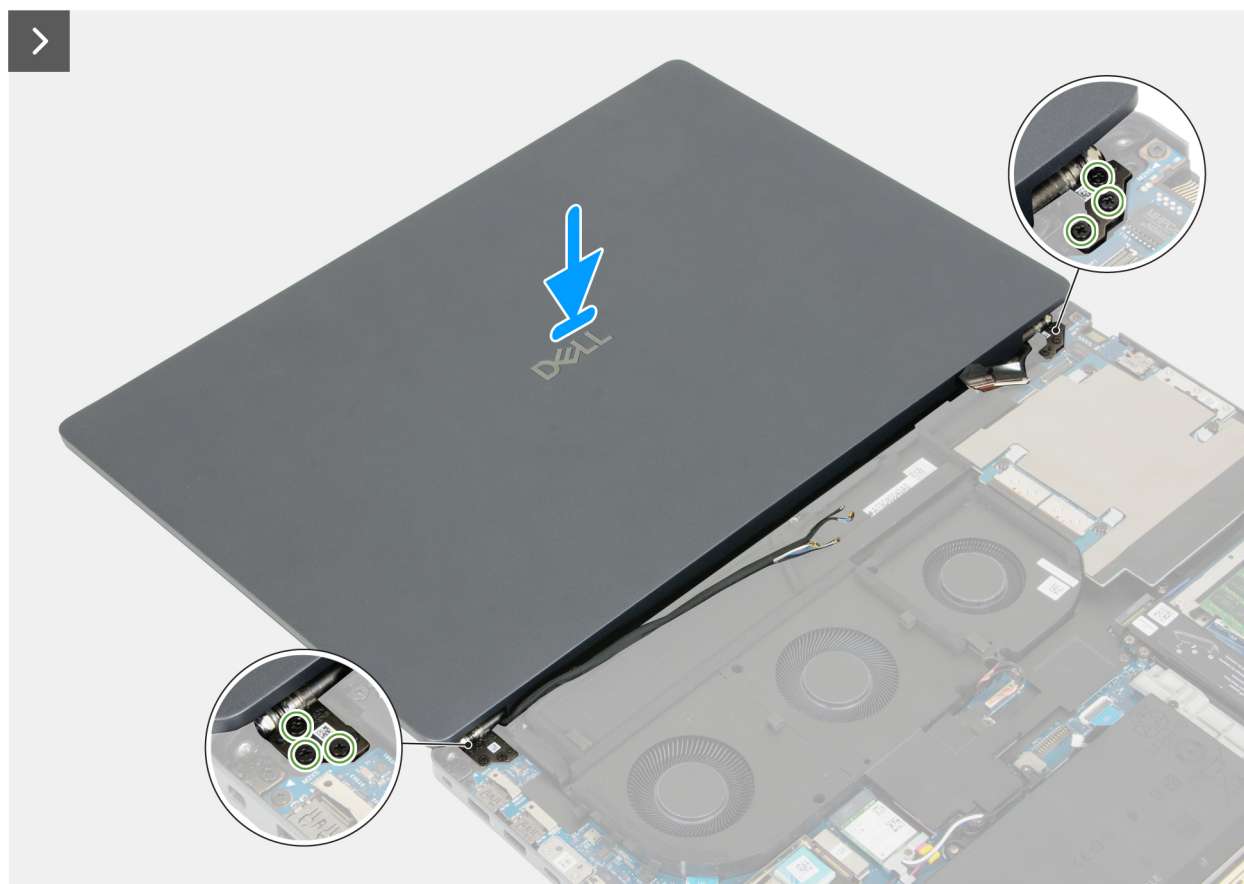
Ilustración 65. Instalación del ensamblaje de la pantalla
