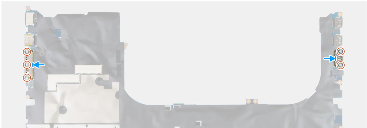
Ilustración 114. Instalación del módulo del conector USB Type-C
