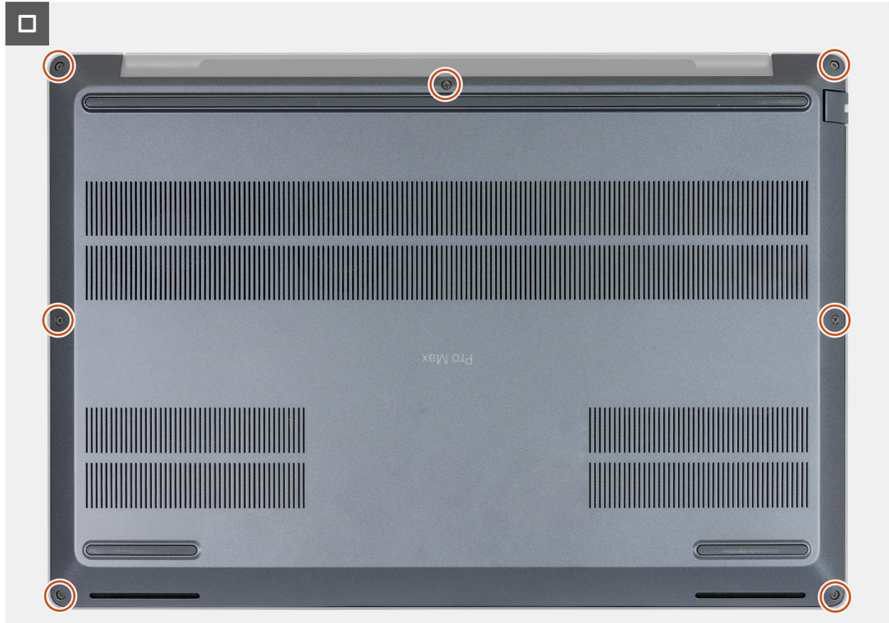
Ilustración 29. Ajuste de los tornillos cautivos
