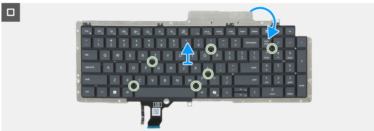
Ilustración 118. Extracción del teclado
