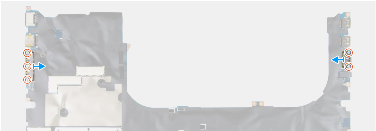
Ilustración 113. Extracción del módulo del conector USB Type-C
